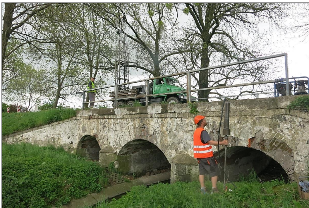
Realizace sondy dynamické penetrace.
