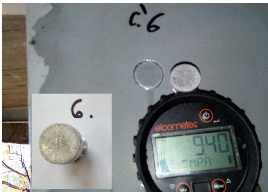
Odtrh č.6 provedený odtrh na levém nosníku u O1, prům. tl. 2276 \mu m, odtrhová pevnost 9,40 MPa, 100% Y
