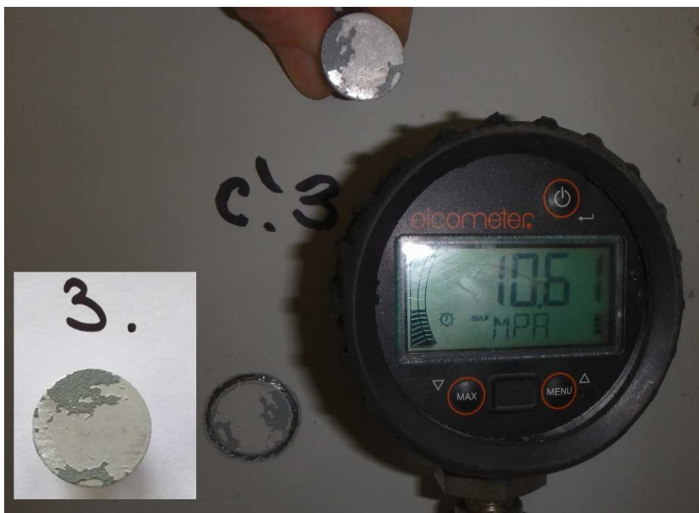
Odtrh č.3 provedený na výztuze levého nosníku u O4, prům. tl. 287 \mu m, odtrhová pevnost 10,61 MPa, 80% Y/Z, 20% D
