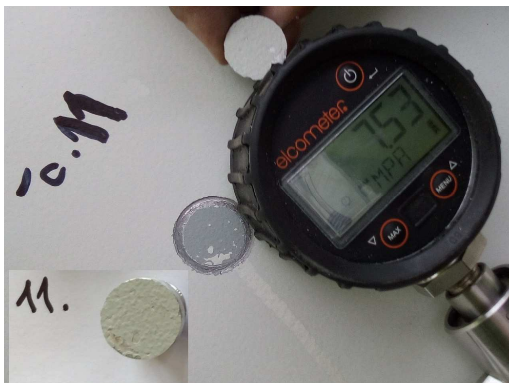
Odtrh č.11 provedený odtrh na levém hlavním nosníku uprostřed hlavního pole, prům. tl. 299 \mu m, odtrhová pevnost 7,53 MPa, 5% Y/Z, 95% D/E
