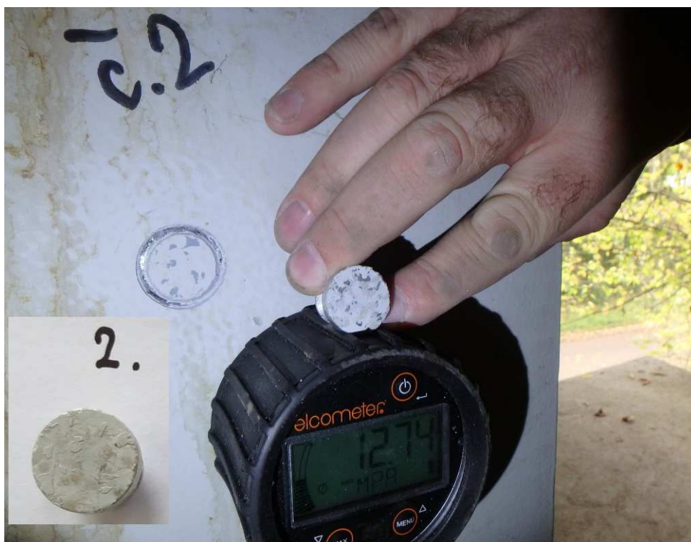
Odtrh č.2 provedený na konci levého nosníku u O4, prům. tl. 484 \mu m, odtrhová pevnost 11,74 MPa, 20% E/Y, 80% E
