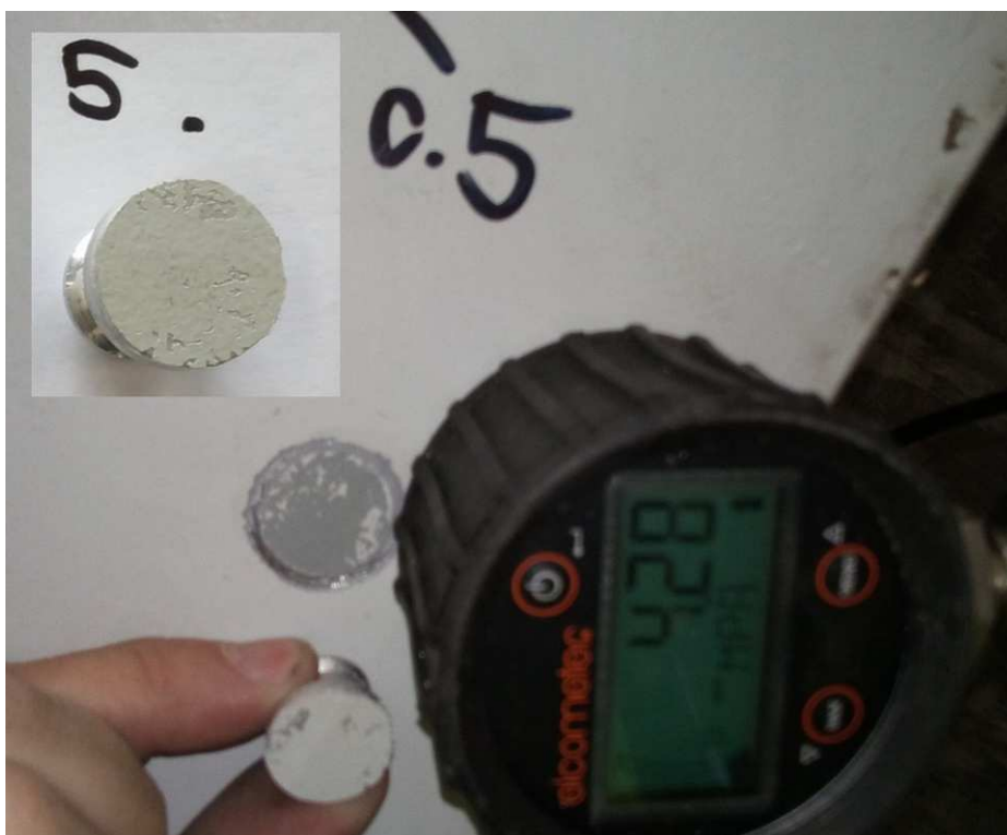
Odtrh č.5 provedený odtrh na pravém nosníku u O1, prům. tl. 295 \mu m, odtrhová pevnost 4,28 MPa, 10% Y/Z, 90% D/E
