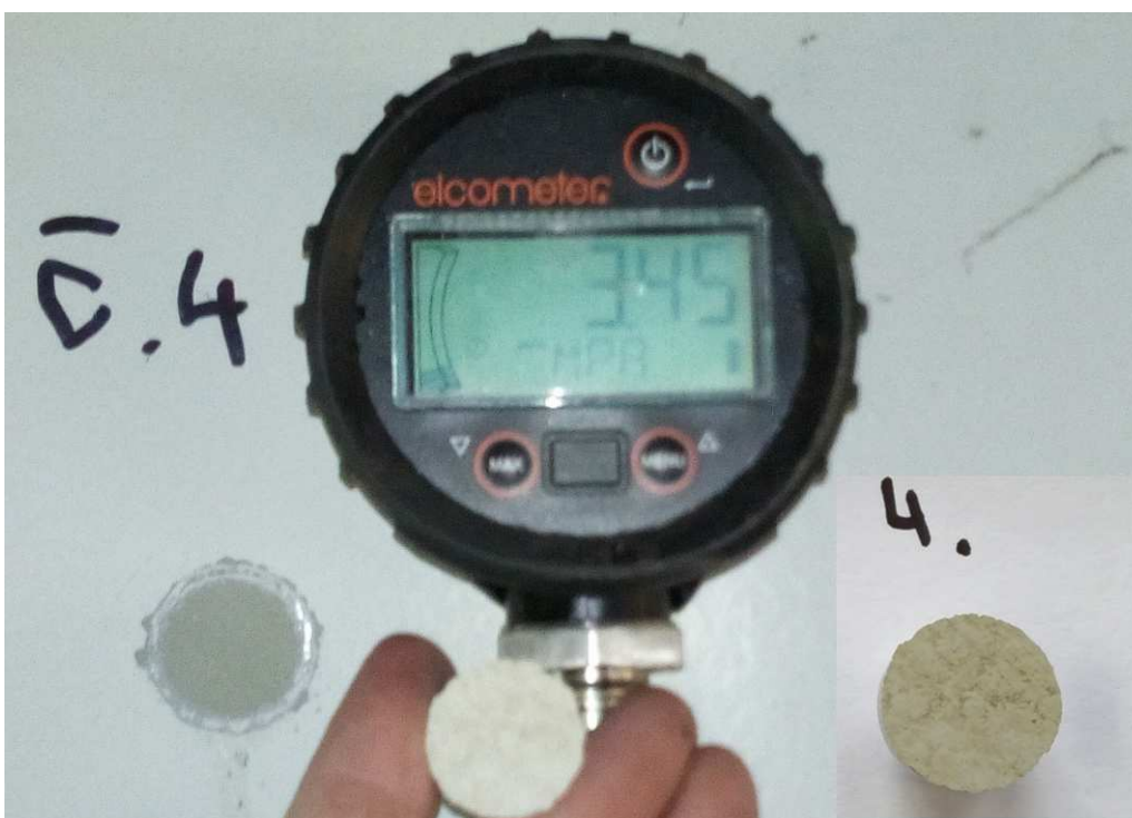
Odtrh č.4 provedený na příčnici O1 směrem do pole, prům. tl. 489 \mu m, odtrhová pevnost 3,45 MPa, 100% D/E
