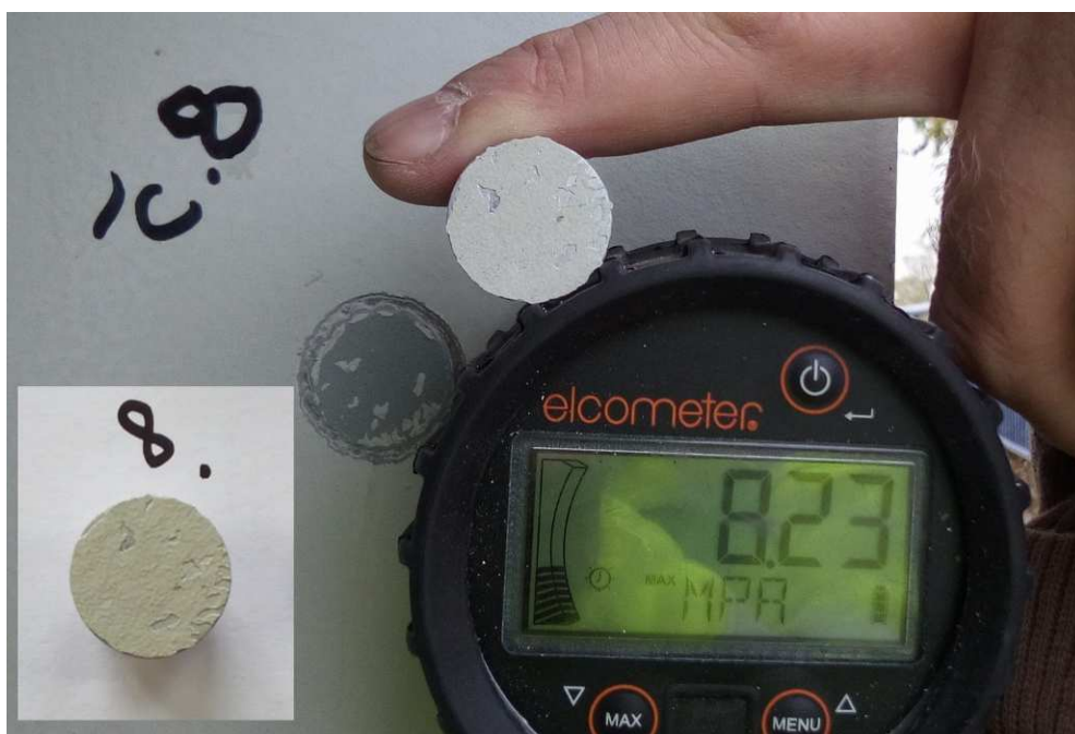
Odtrh č.8 provedený odtrh na pravém hlavním nosníku v patě oblouku, prům. tl. 336 \mu m, odtrhová pevnost 8,23 MPa, 5% Y/Z, 95% D/E
