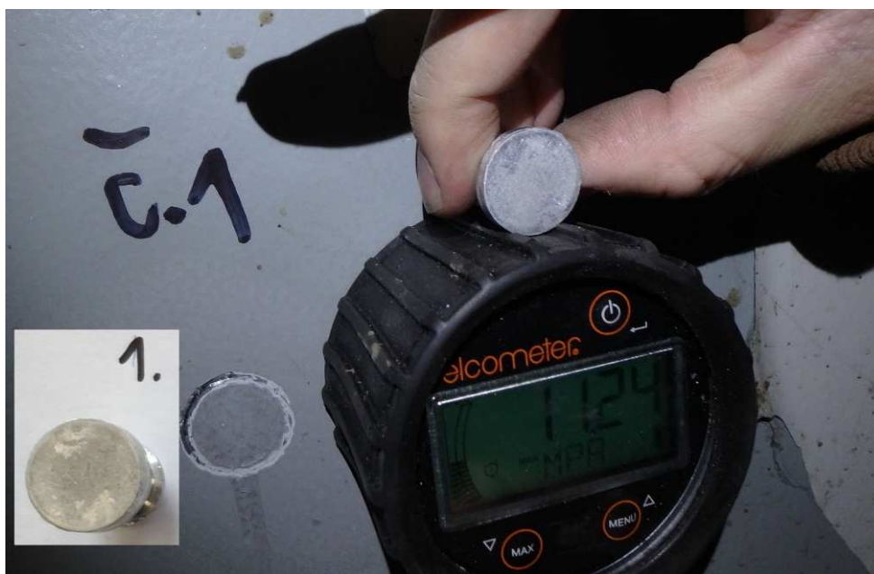
Odtrh č.1 provedený na zadní ploše stěny koncového příčnicku u O4, prům. tl. 393 \mu m, odtrhová pevnost 11,24 MPa, 100% E/Y
