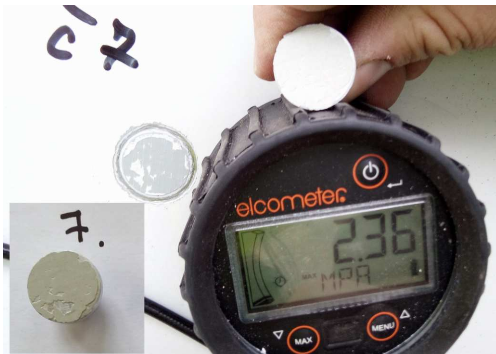
Odtrh č.7 provedený odtrh na pravém hlavním nosníku v poli 1, prům. tl. 319 \mu m, odtrhová pevnost 2,36 MPa, 10% Y/Z, 90% D/E
