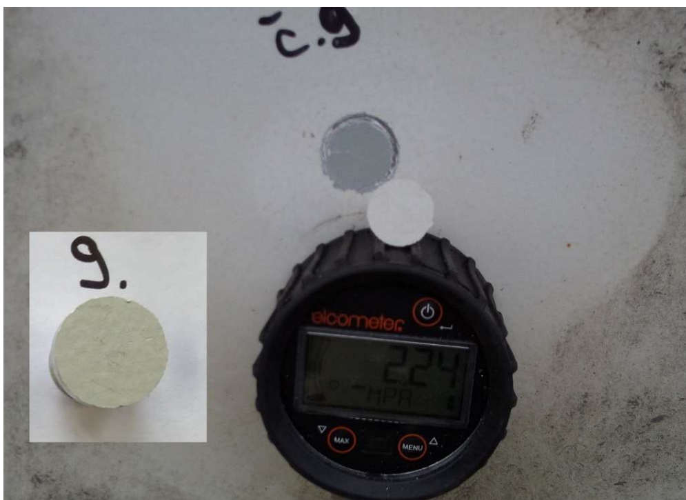
Odtrh č.9 provedený na levém hlavním nosníku u O4 směrem do vozovky, prům. tl. 289 \mu m, odtrhová pevnost 2,24 MPa, 100% D/E
