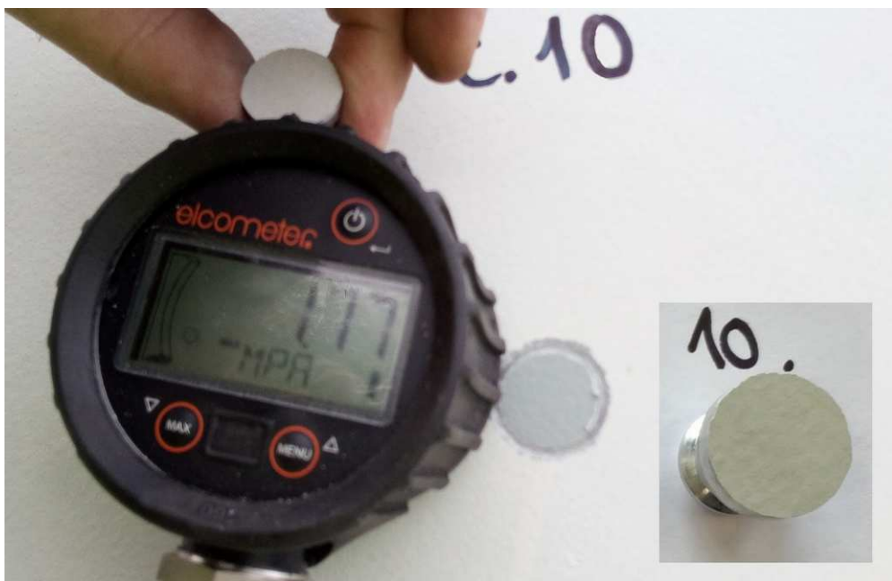
Odtrh č.10 provedený na levém hlavním nosníku v patě oblouku, prům. tl. 339 \mu m, odtrhová pevnost 1,17 MPa, 100% D/E
