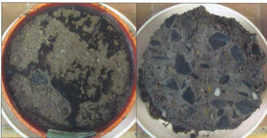
Foto 6: Pohled na čelo a dno vzorku CHRL2 – po CH.R.L. - metoda C – 75 cyklů (zaznamenán částečný rozpad dna zkušební vzorku)
