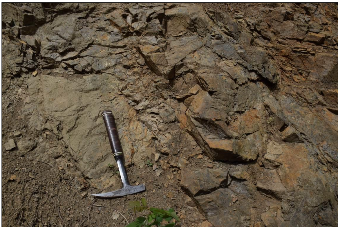
Foto 4 Silné rozpukání a rozvolnění horninového masivu v lici předmětného skalního svahu – detail.
