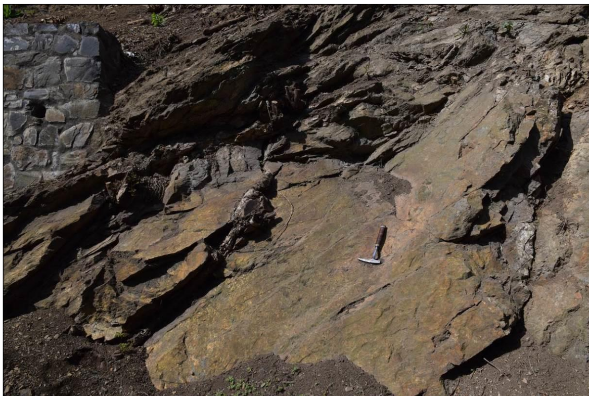
Foto 6 Šikmo po svahu ukloněné diskontinuity kosé k orientaci svahu – detail v patě skalního svahu.
