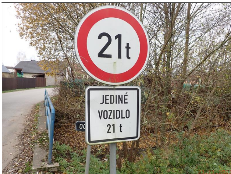
4.3 Dopravní značky neodpovídají aktuální zatížitelnosti.JPG
