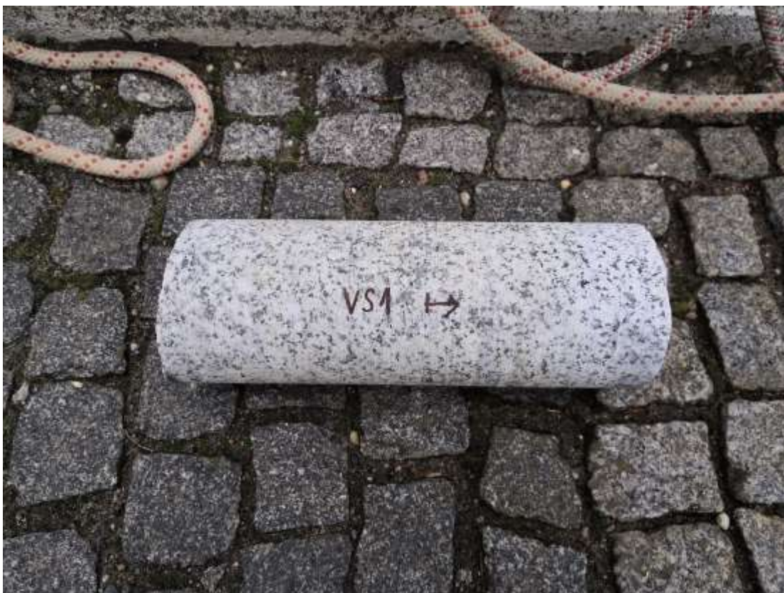
Fotografie č.1 – jádrový vývrt VS1 (pilíř P3)
