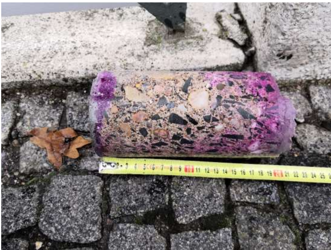
Fotografie č.3 – jádrový vývrt VH2A (pilíř P2)
