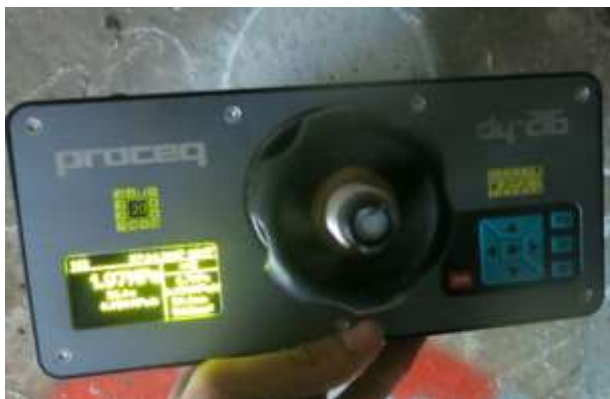
Obr. 3.3 Odrhový přístroj DY-216 od firmy Proceq
