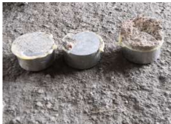
Obr. 3.4 Zkušební terče po odtržení
