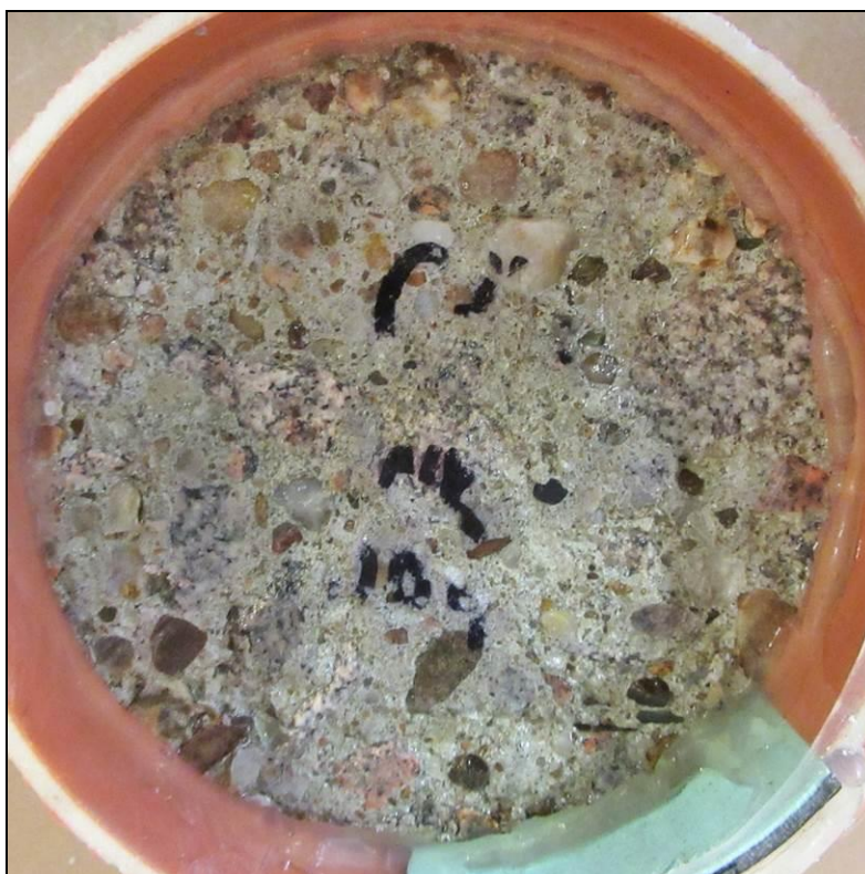
Foto 36: Pohled na líc vzorku CH4 NK – po CH.R.L. - metoda C – 75 cyklů
