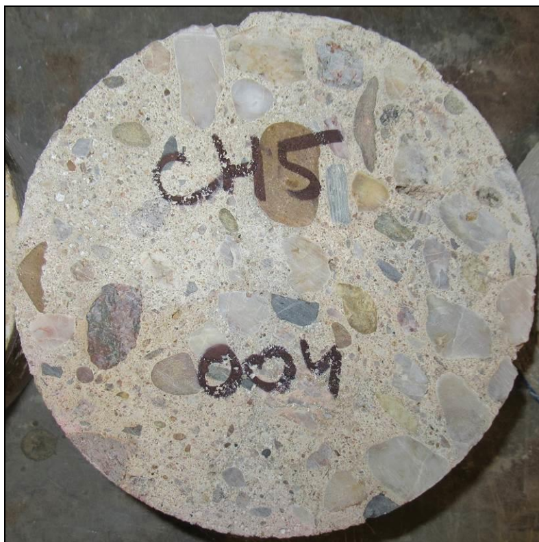
Foto 21: Pohled na líc vývrtu CH5 před zkouškou
