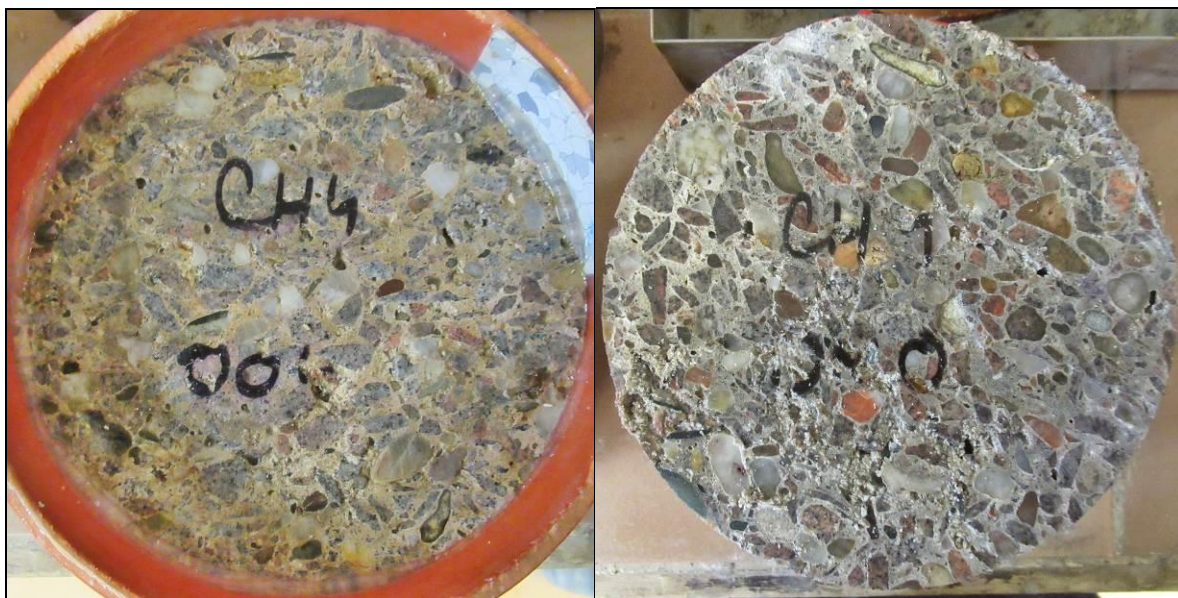
Foto 20: Pohled na líc a „dno“ vzorku CH4 – po CH.R.L. - metoda C – 75 cyklů
