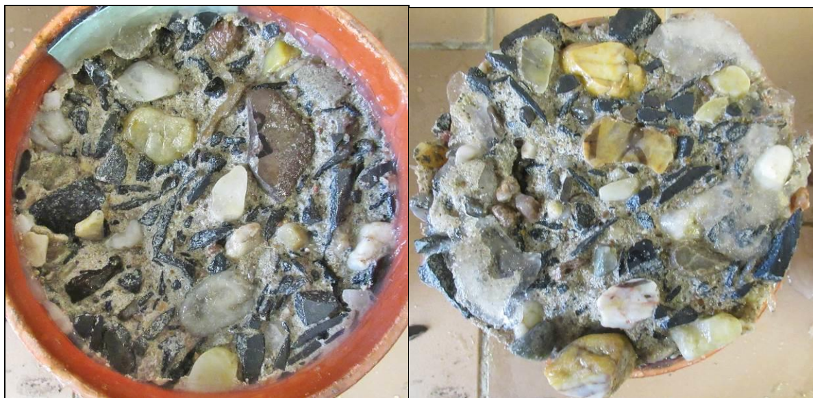
Foto 28: Pohled na líc a „dno“ vzorku CH8 – po CH.R.L. - metoda C – 50 cyklů
