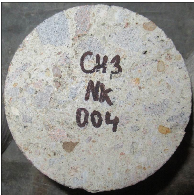
Foto 33: Pohled na líc vývrtnu CH3 NK před zkouškou
