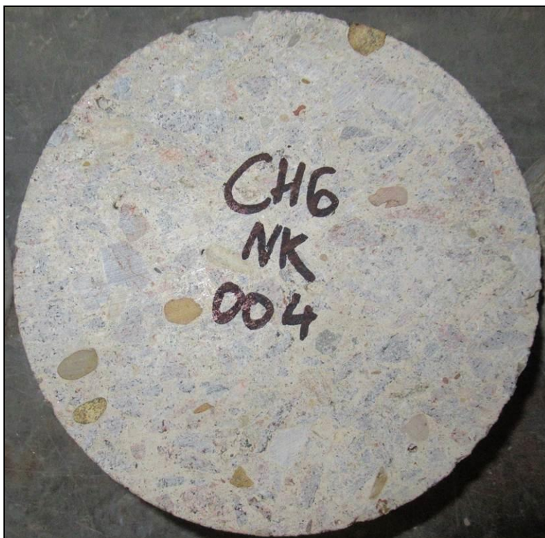
Foto 39: Pohled na líc vývrtu CH6 NK před zkouškou
