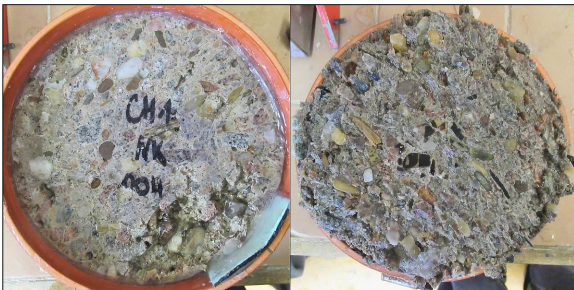
Foto 30: Pohled na líc a „dno“ vzorku CH1 NK – po CH.R.L. - metoda C – 50 cyklů
