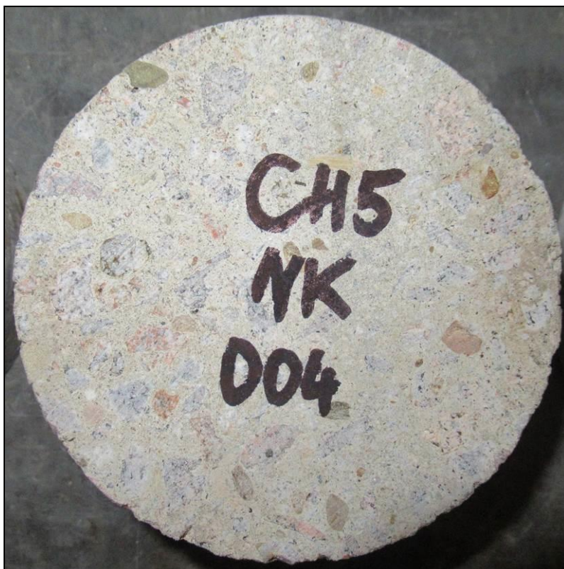
Foto 37: Pohled na líc vývrtnu CH5 NK před zkouškou
