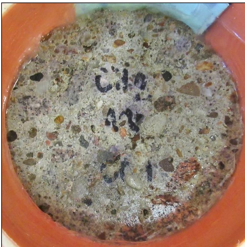
Foto 32: Pohled na líč vzorku CH2 NK – po CH.R.L. - metoda C – 75 cyklů
