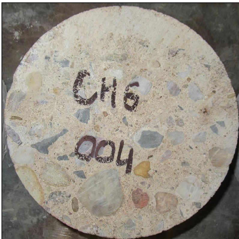
Foto 23: Pohled na líc vývrtu CH6 před zkouškou
