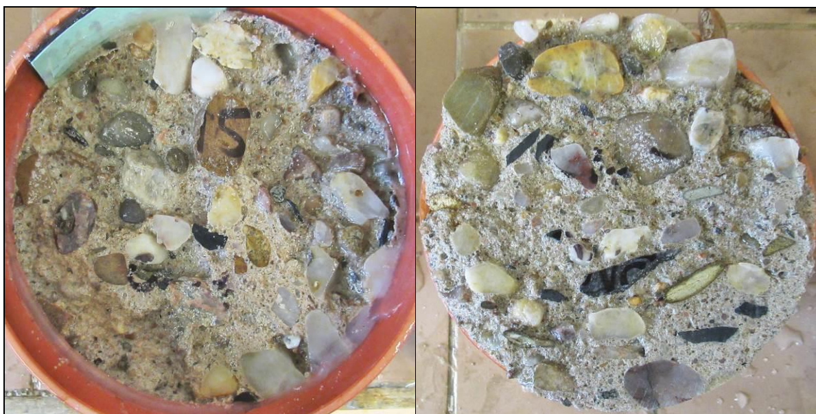
Foto 22: Pohled na líc a „dno“ vzorku CH5 – po CH.R.L. - metoda C – 50 cyklů
