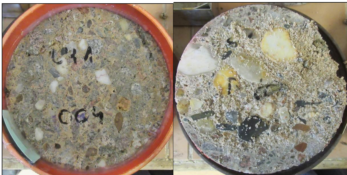
Foto 14: Pohled na líc a „dno“ vzorku CH1 – po CH.R.L. - metoda C – 75 cyklů
