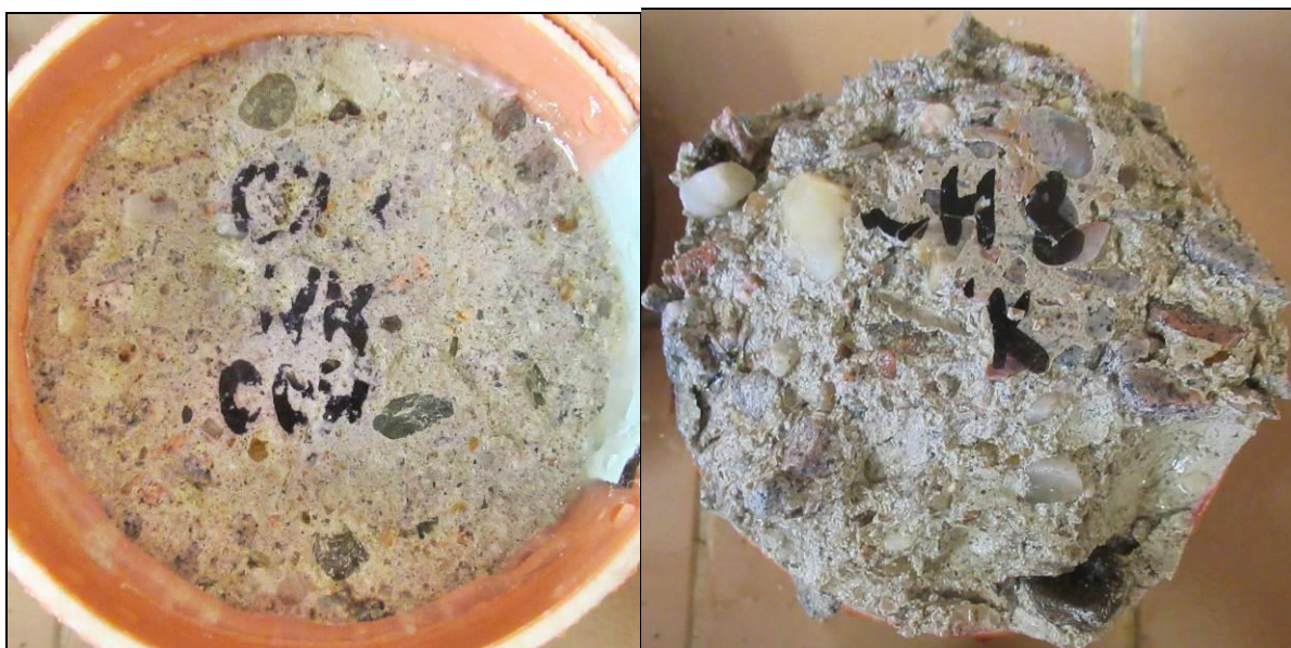
Foto 44: Pohled na líc a „dno“ vzorku CH8 NK – po CH.R.L. - metoda C – 50 cyklů
