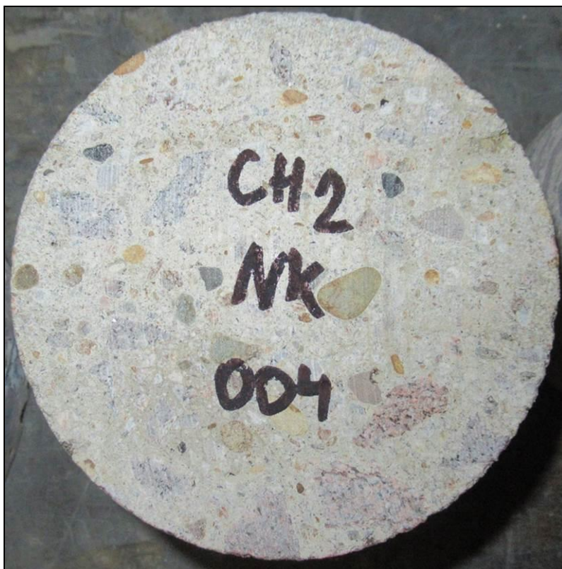
Foto 31: Pohled na líč vývrtnu CH2 NK před zkouškou
