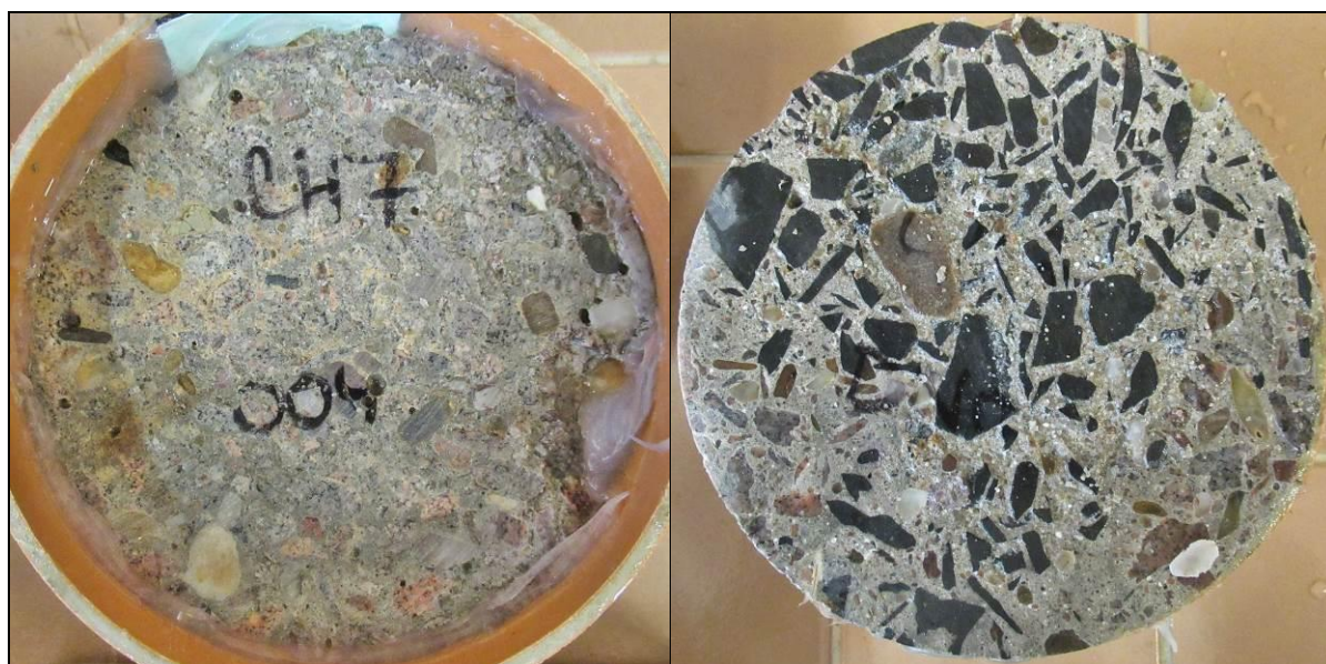
Foto 26: Pohled na líc a „dno“ vzorku CH7 – po CH.R.L. - metoda C – 75 cyklů
