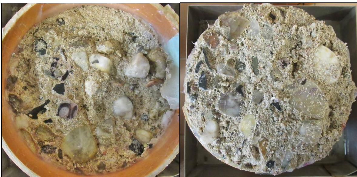
Foto 24: Pohled na líc a „dno“ vzorku CH6 – po CH.R.L. - metoda C – 75 cyklů
