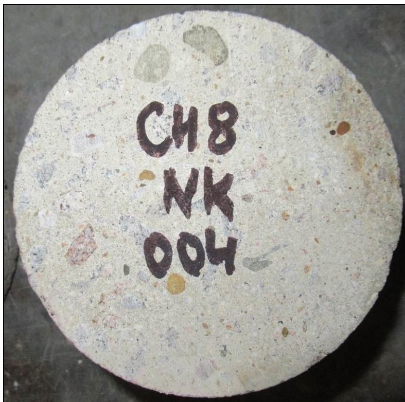
Foto 43: Pohled na líc vývrtu CH8 NK před zkouškou
