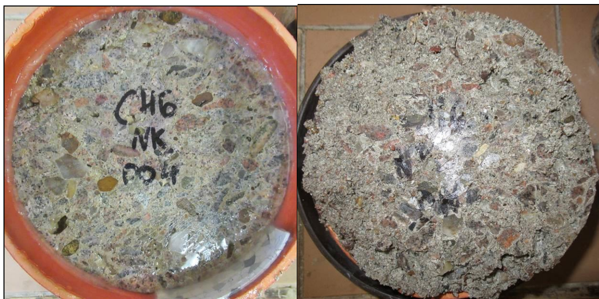
Foto 40: Pohled na líc a „dno“ vzorku CH6 NK – po CH.R.L. - metoda C – 75 cyklů
