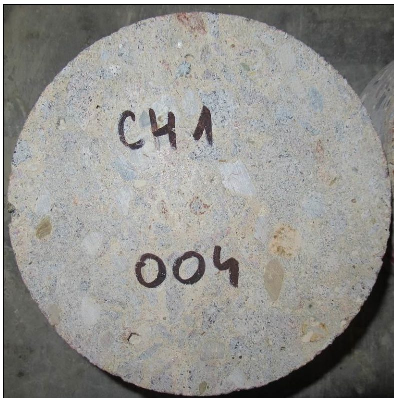
Foto 13: Pohled na líc vývrtu CH1 před zkouškou
