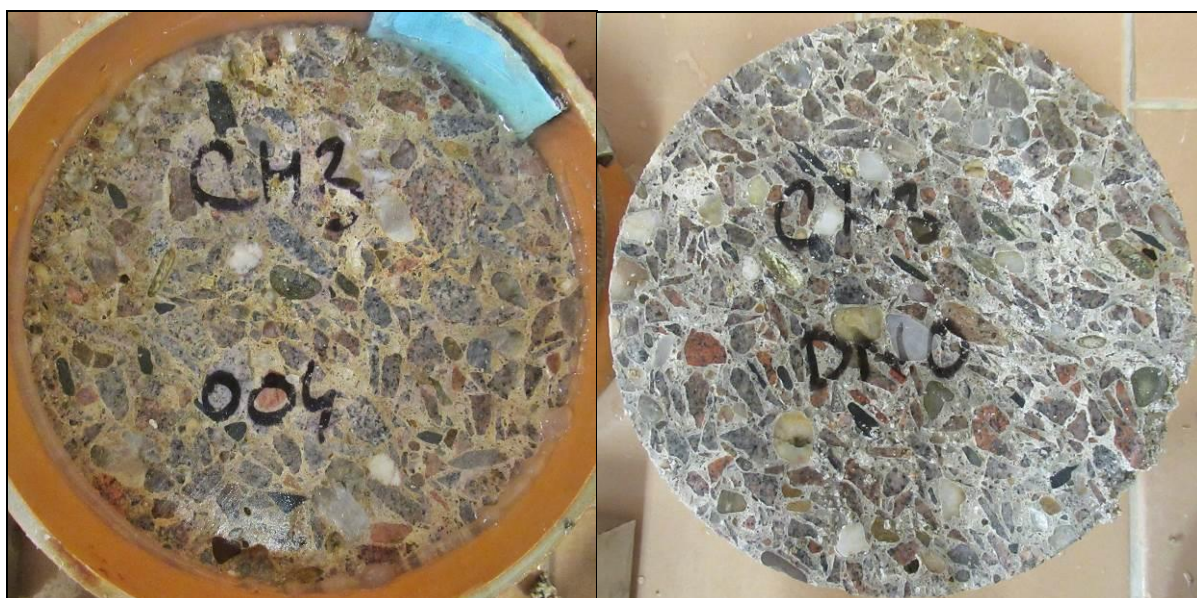
Foto 18: Pohled na líc a „dno“ vzorku CH3 – po CH.R.L. - metoda C – 75 cyklů
