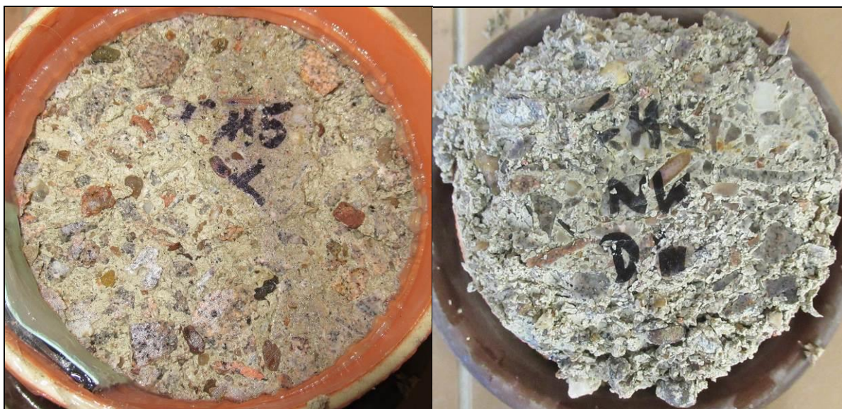
Foto 38: Pohled na líc a „dno“ vzorku CH5 NK – po CH.R.L. - metoda C – 75 cyklů
