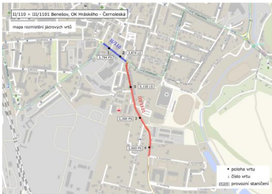
Obr. 1 - Situace úseku včetně vyznačení odebraných jádrových vývrtů
