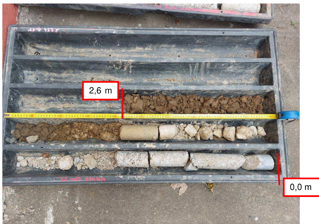
Foto č.2 – jádro vrtu V2 opěra sever - směr Kralupy
