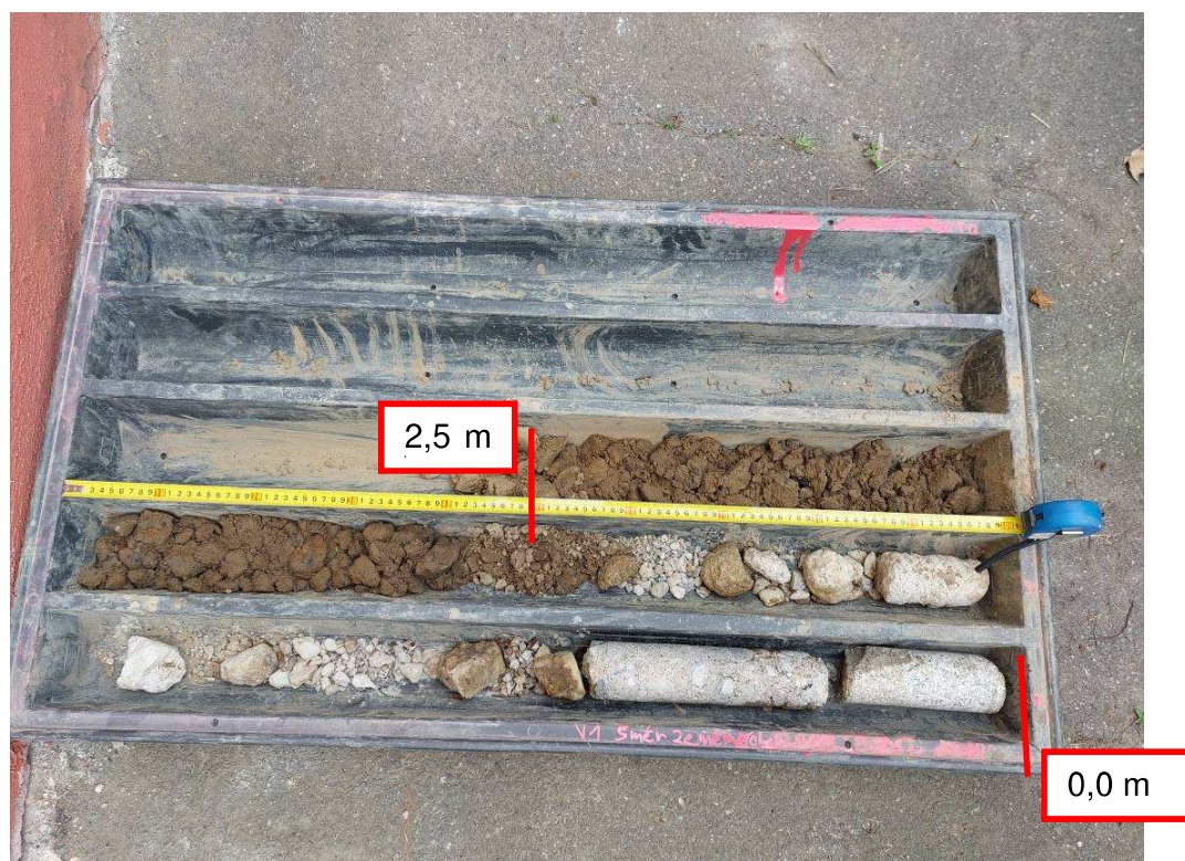
Foto č.1 – jádro vrtu V1 opěra jih - směr Zeměchy
