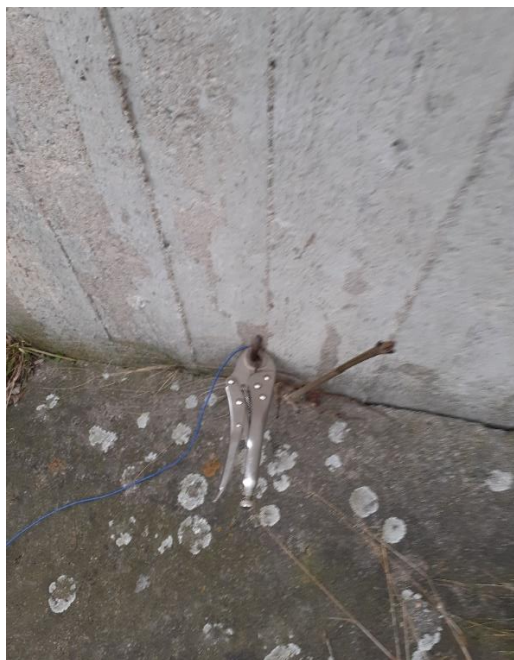
Obrázek 2 – Měřená obnažená výztuž na opěře
