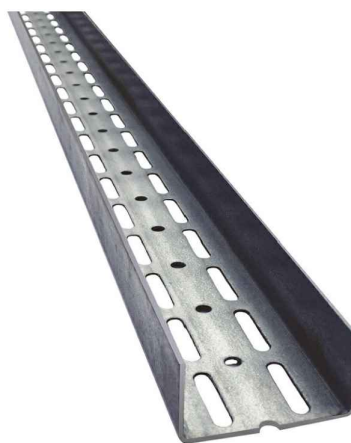
Pro stavební otvory větší než 1000mm budou použity překlady z UA profilů s uložením 250mm
