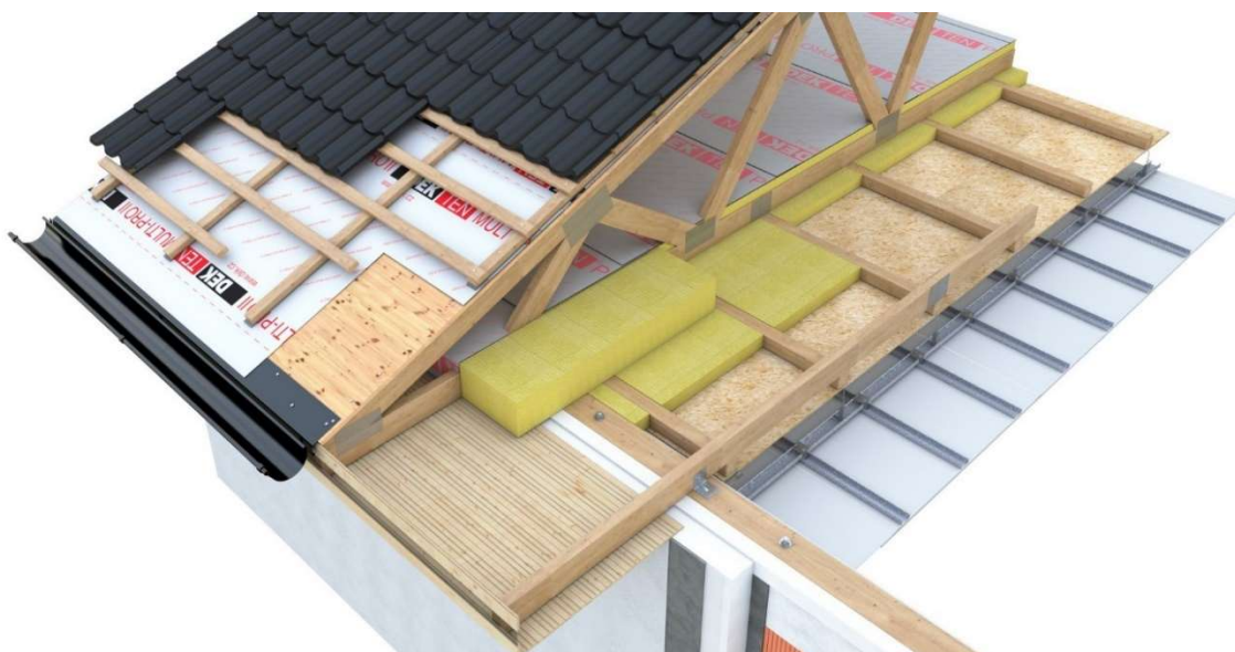
Obrázek 4.1.2: Systém zateplení stropní konstrukce (Zdroj: deksoft.eu)
