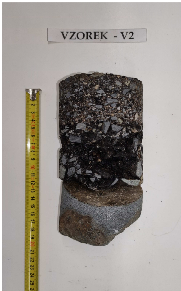
Obr. 4 - Jádru vývrtu Vzorek – V2 (laboratoř).
