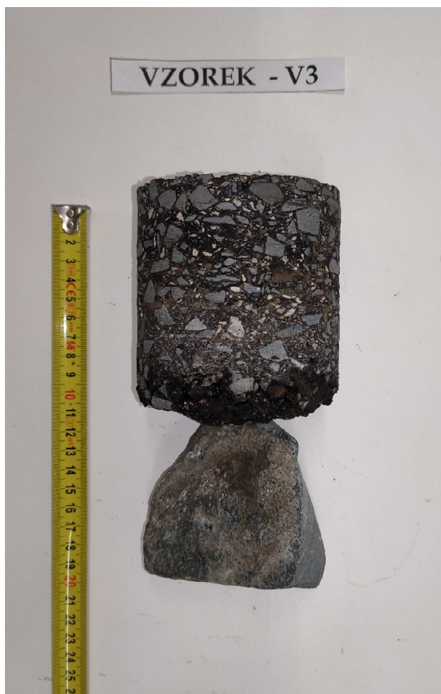
Obr. 6 - Jádru vývrtu Vzorek – V3 (laboratoř).
