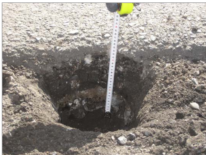
foto 19: Detail konstrukční skladby vozovky v sondě S-5
