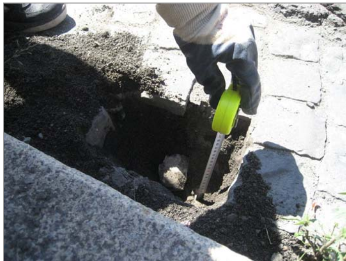
foto 14: Detail konstrukční skladby vozovky v sondě S-2
