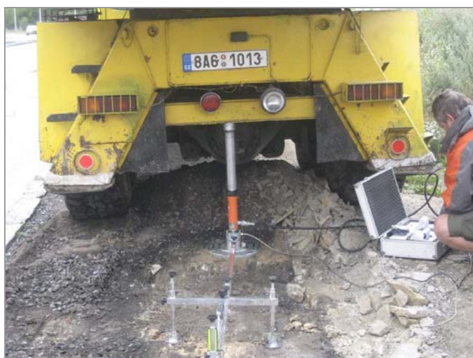
foto 6: Sestava statické zatěžovací zkoušky Z-3
