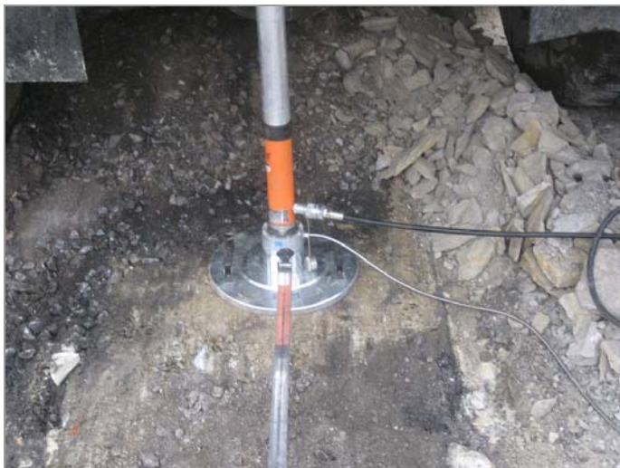
foto 7: Detail sestavy zatěžovací zkoušky Z-3
