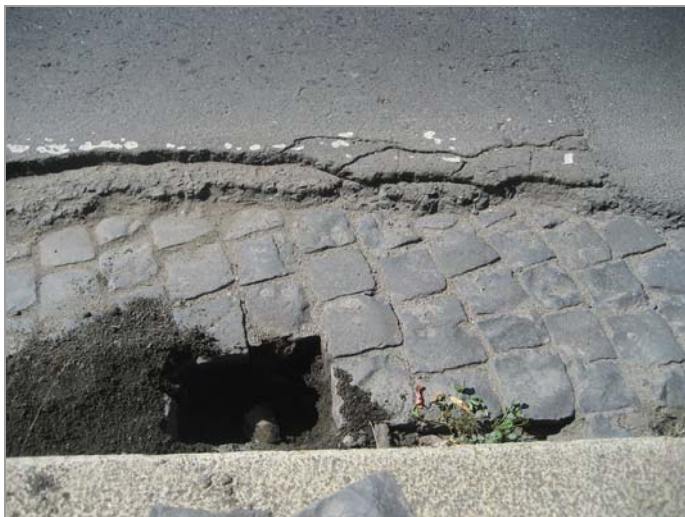
foto 13: Kopaná sonda S-2 pro ověření konstrukce vozovky
