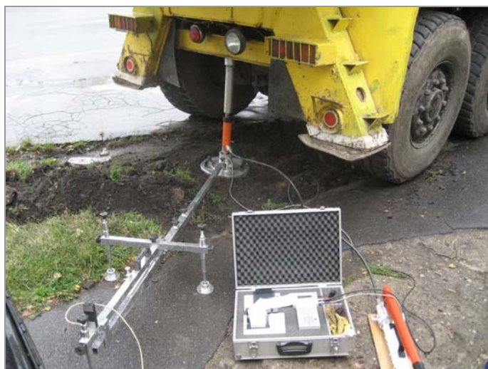
foto 2: Detail sestavy zatěžovací zkoušky Z-1
