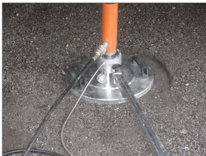
foto 4: Detail sestavy zatěžovací zkoušky Z-2
