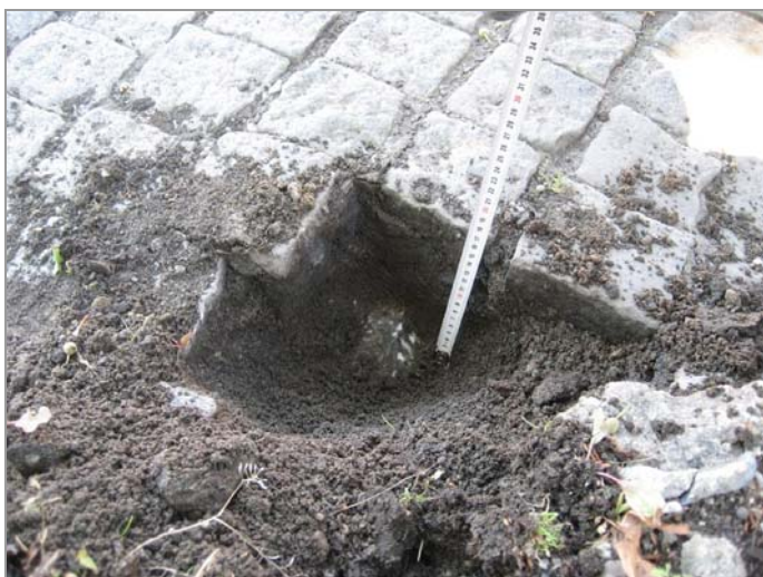
foto 15: Detail konstrukční skladby vozovky v sondě S-3
