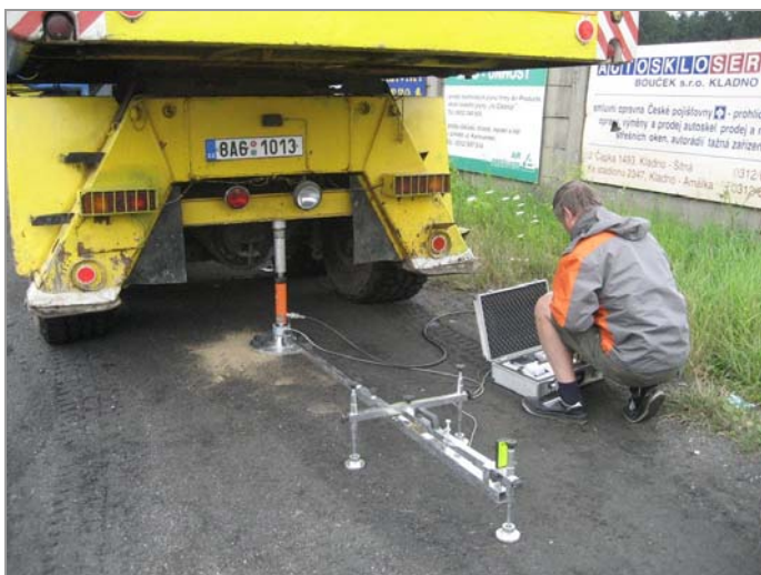
foto 9: Sestava statické zatěžovací zkoušky Z-5
