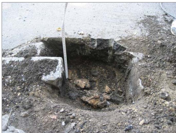
foto 12: Detail konstrukční skladby vozovky v sondě S-1
