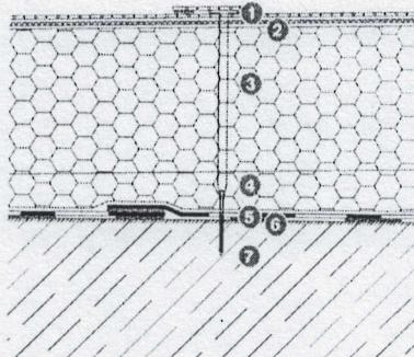
Doporučený minimální sklon povrchu střech pro zajištění dostatečného odtoku vody je  $1,7^\circ$  (3 %). Maximální sklon střešního pláště pro zajištění stability vrstev kotvením je  $5^\circ$  (8,7 %). Při sklonu větším než  $5^\circ$  je třeba obvykle navrhnut opatření, které brání posunu vrstev skladby ve směru spádu.
