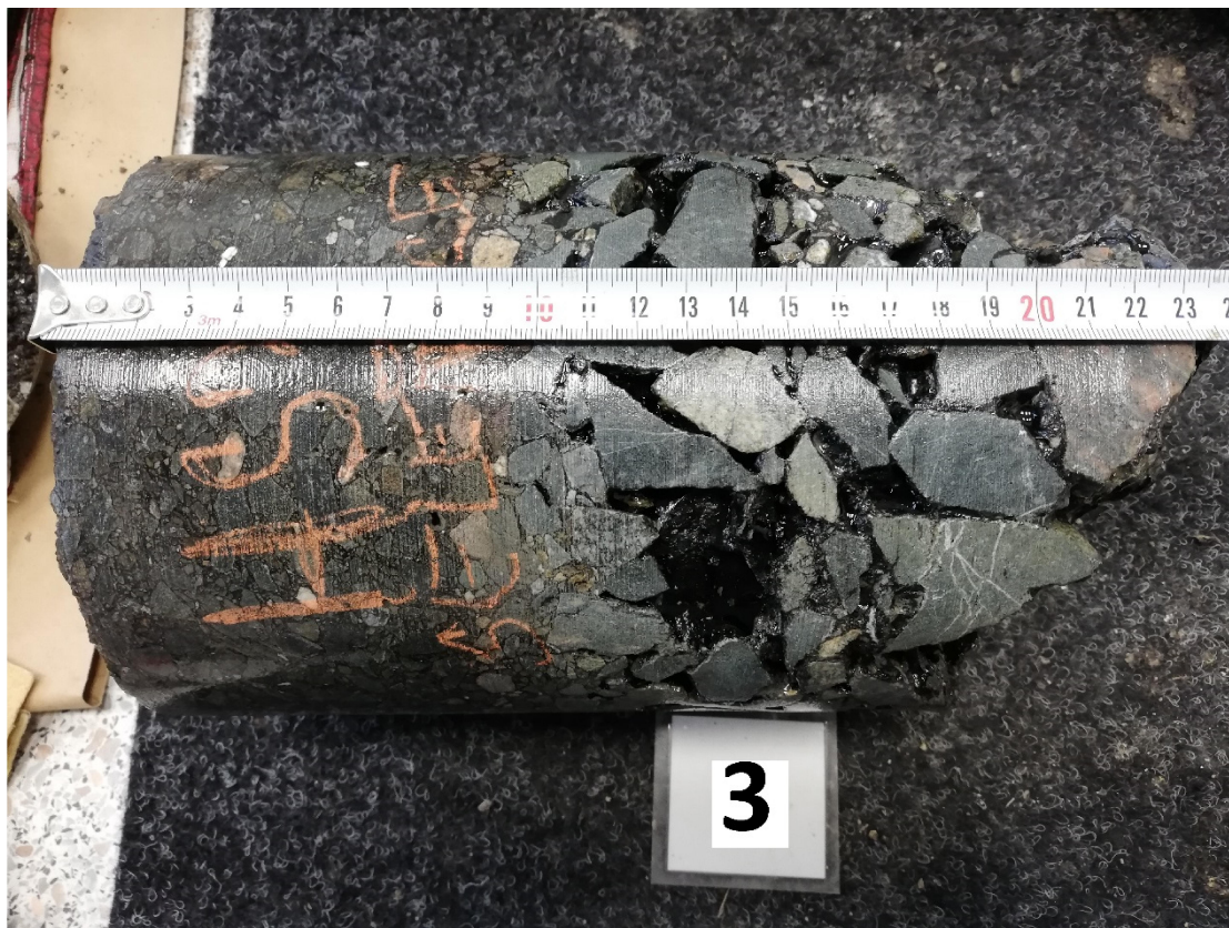
Obr. 9 AC vývrt JV3 z hloubené sondy HS3
