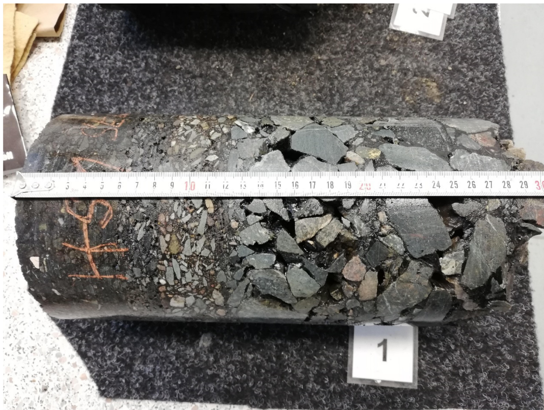
Obr. 7 AC vývrt JV1 z hloubené sondy HS1
