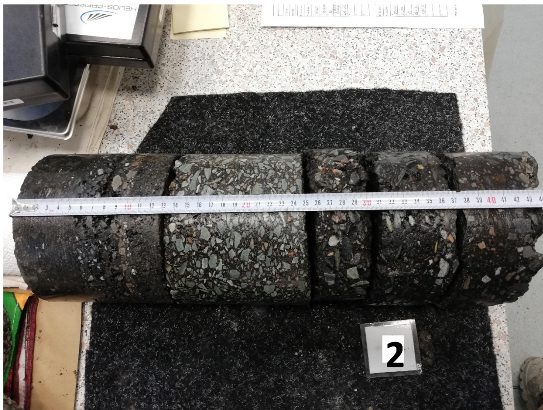
Obr. 8 AC vývrt JV2 z hloubené sondy HS2
