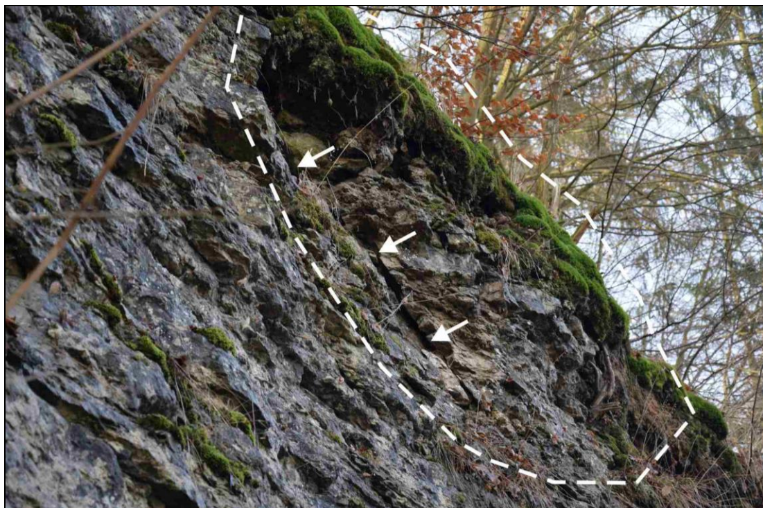
Foto 8 Ukázka nestabilního bloku a převislé části v horní hraně stěny (vyznačeno bílým polygonem). Bílými šipkami je vyznačena otevřená trhlina.
