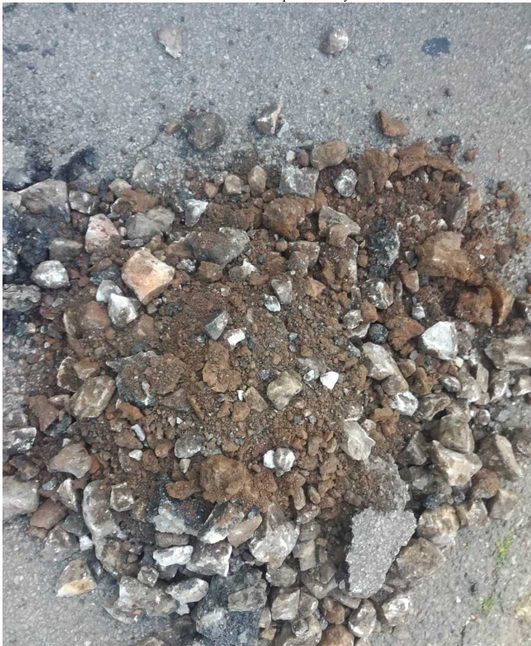
Obrázek B. 5 Materiál konstrukčních vrstev kopané sondy K2
