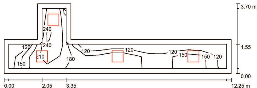
Výška místnosti: 2.600 m, Montážní výška: 2.600 m, Činitel údržby: 0.75      Hodnoty v Lux, Měřítko 1:88
