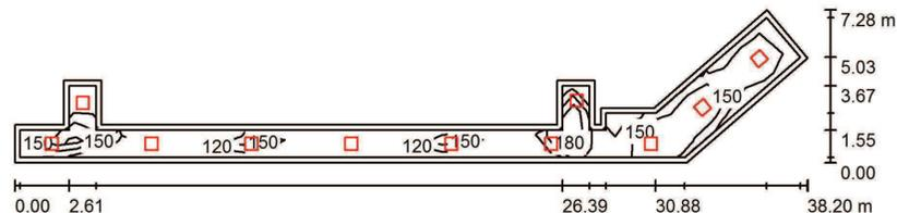
Výška místnosti: 2.600 m, Montážní výška: 2.600 m, Činitel údržby: 0.75      Hodnoty v Lux, Měřítko 1:274
