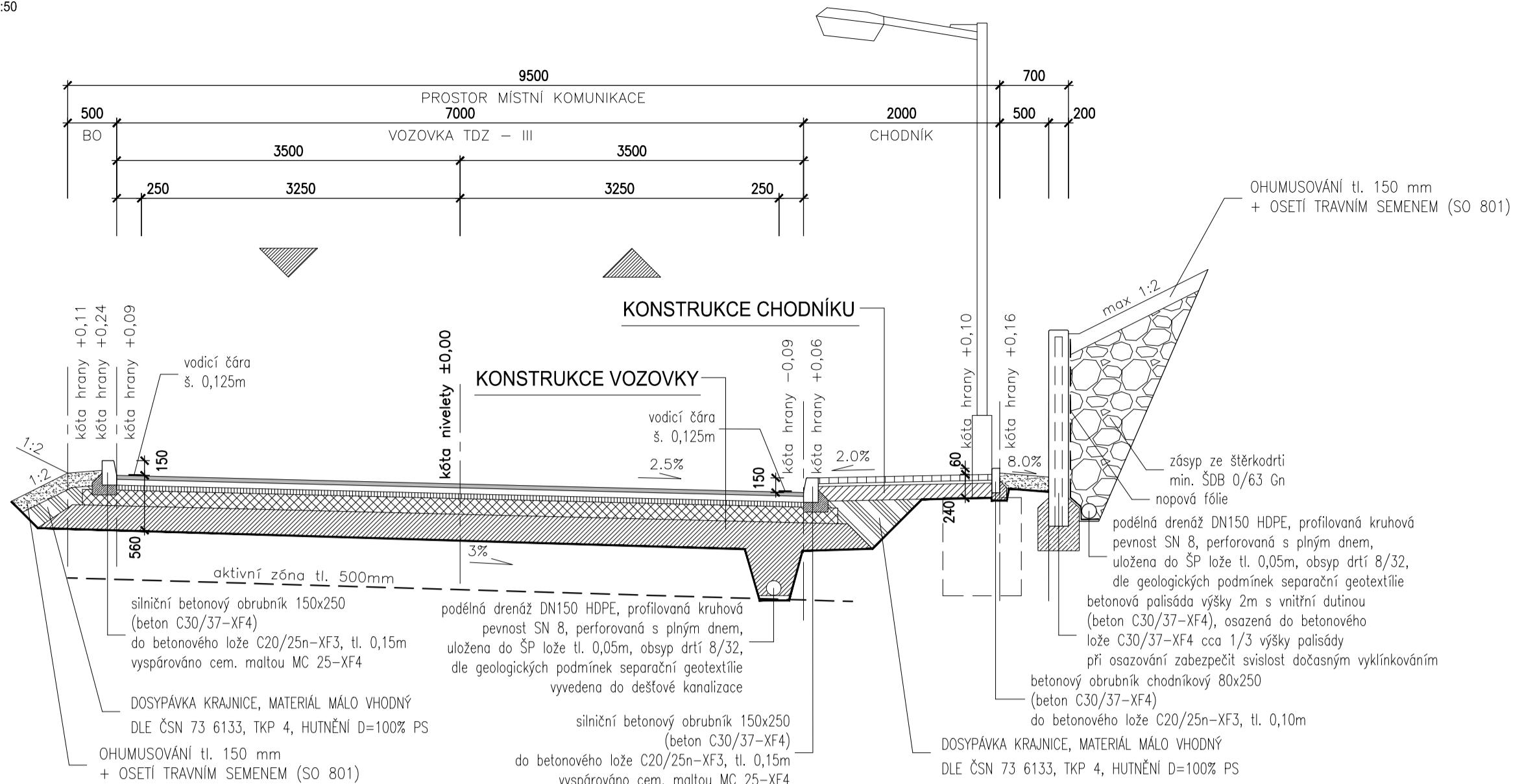
VZOROVÝ PŘÍČNÝ ŘEZ - sklon vozovky k Litavce
