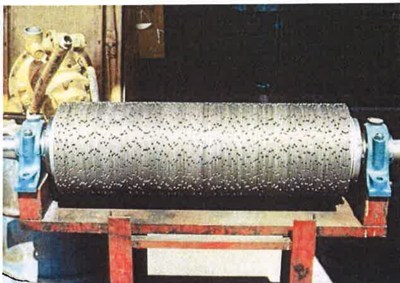
Řezné kotouče na horizontální hřídeli
