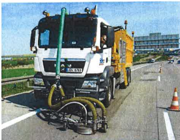
Příklad zapojení sestavy dvou trysek
