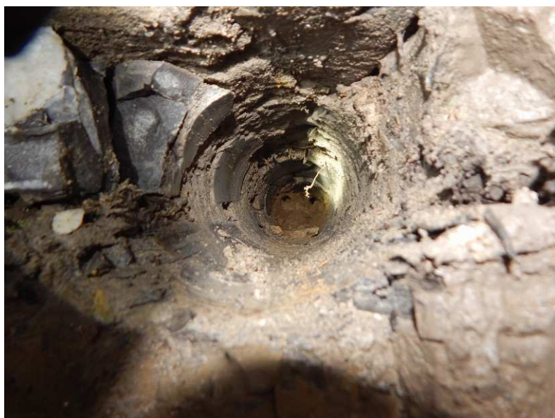
Obr. 3.8 – jádrový vývrt V5
