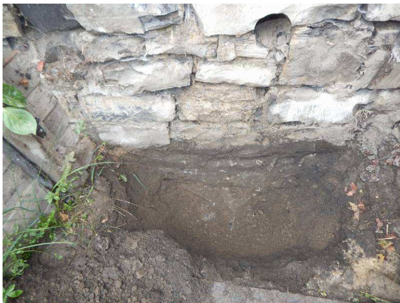
Obr. 3.2 – kopaná sonda KS1 s odhaleným skalním masivem
