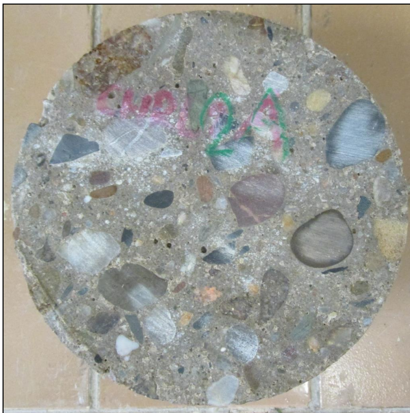
Foto 5: Celkový pohled na čelo vývrtu CHRL2 před zkouškou (po zarovnání)
