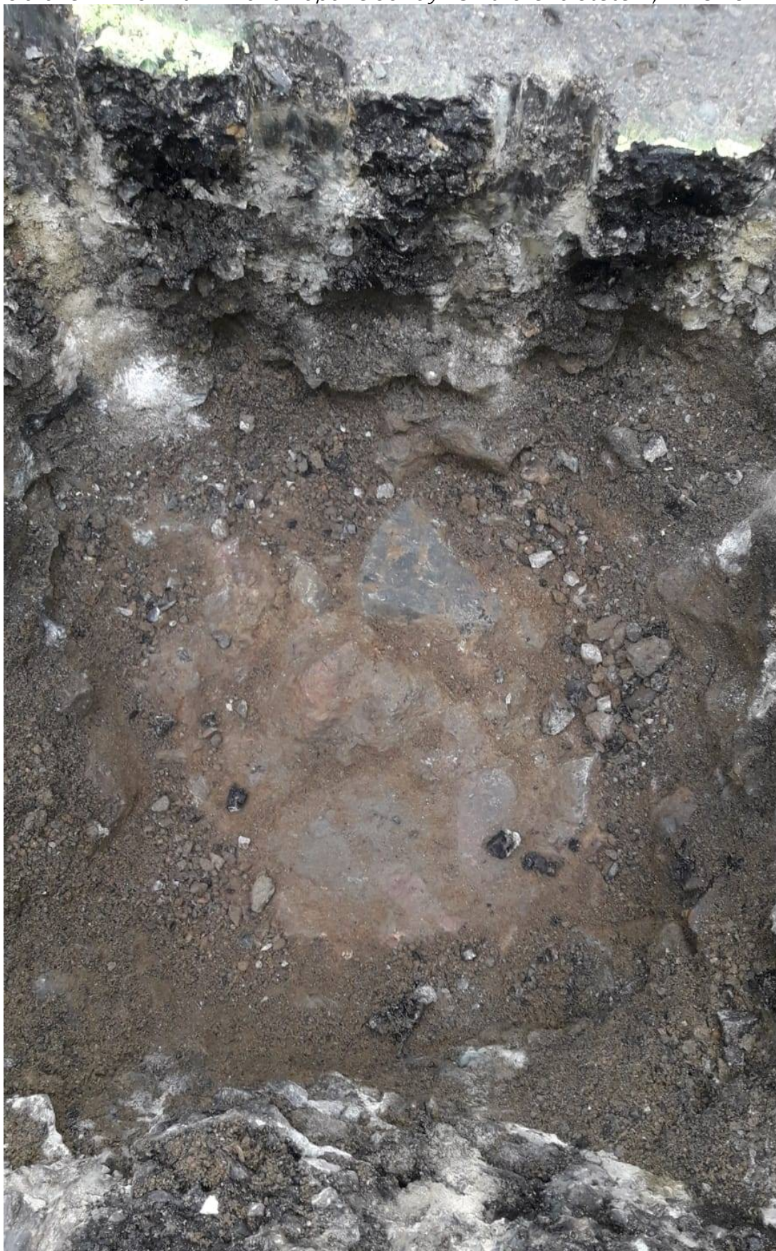
Obrázek B. 19 Aktivní zóna kopané sondy ZS2 tvořená štětem, km 3.734
