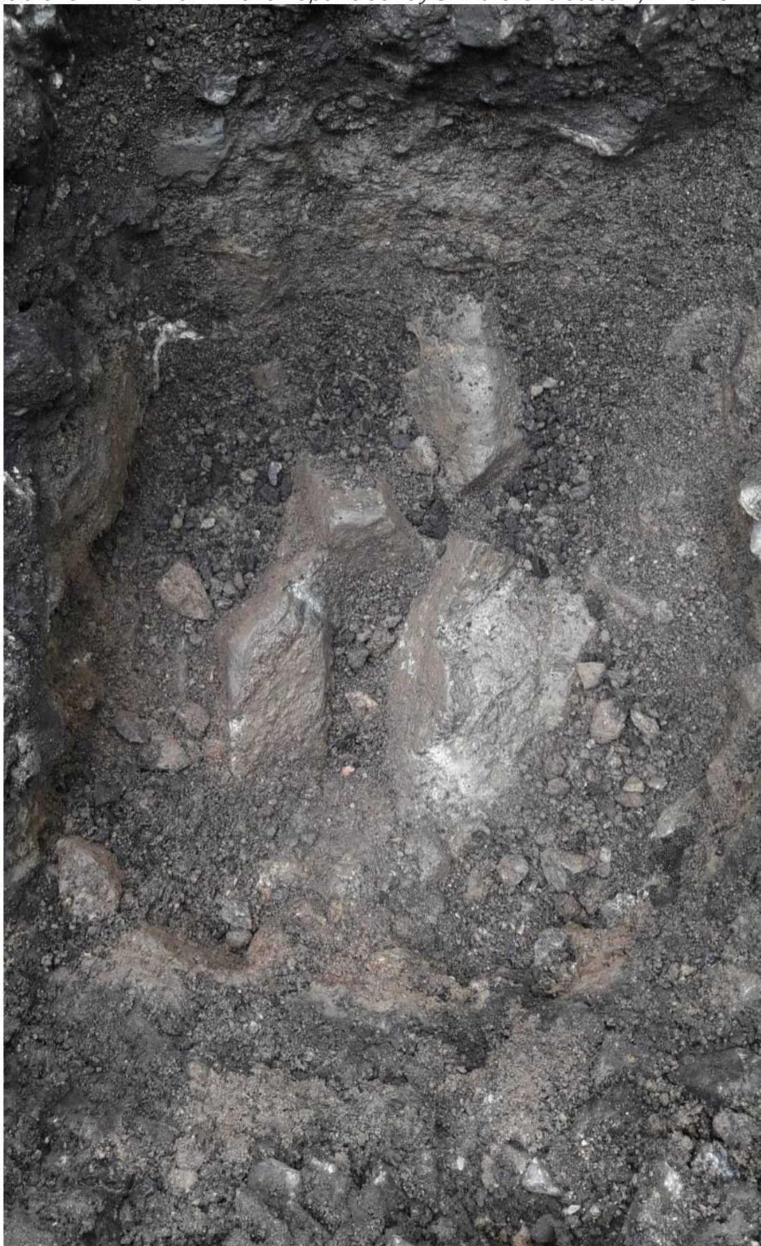
Obrázek B. 15 Aktivní zóna kopané sondy SZ1 tvořená štětem, km 3.734
