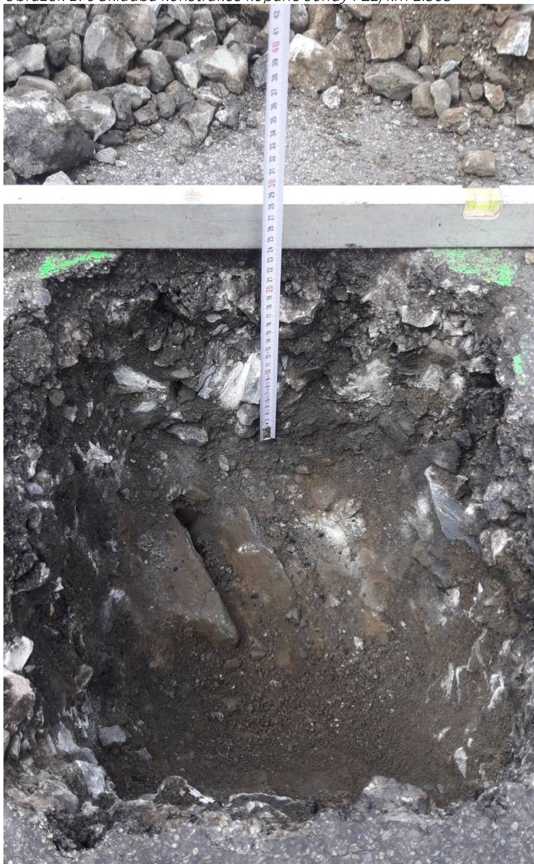
Obrázek B. 6 Skladba konstrukce kopané sondy PZ2, km 2.303
