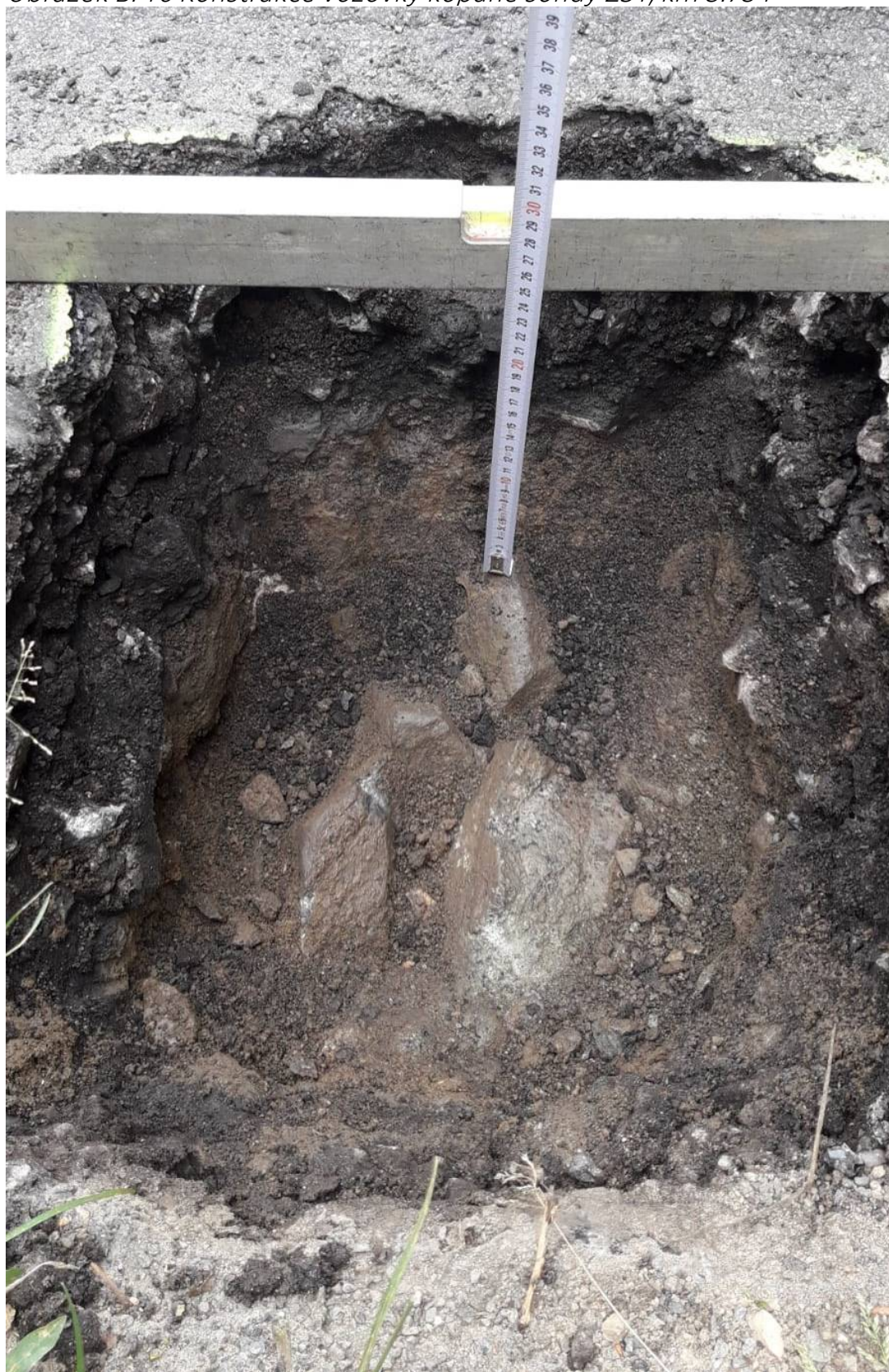
Obrázek B. 16 Konstrukce vozovky kopané sondy ZS1, km 3.734
