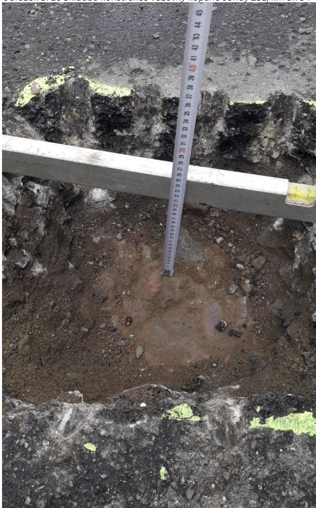
Obrázek B. 20 Skladba konstrukce vozovky kopané sondy ZS2, km 3.734
