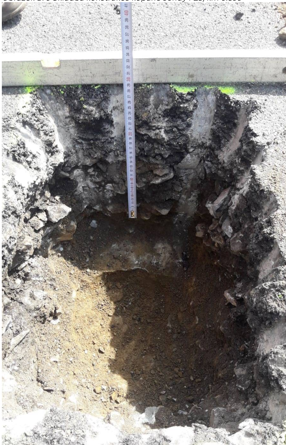
Obrázek B. 9 Skladba konstrukce kopané sondy PZ3, km 0.899
