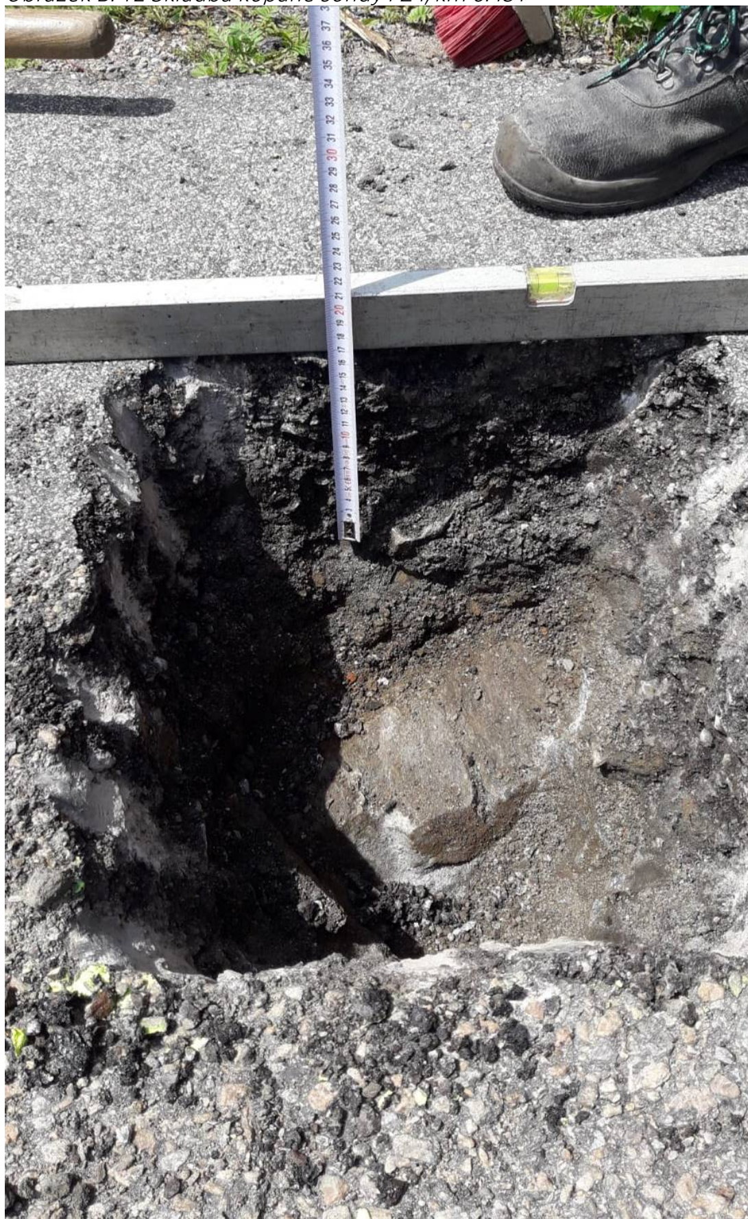
Obrázek B. 12 Skladba kopané sondy PZ4, km 0.431
