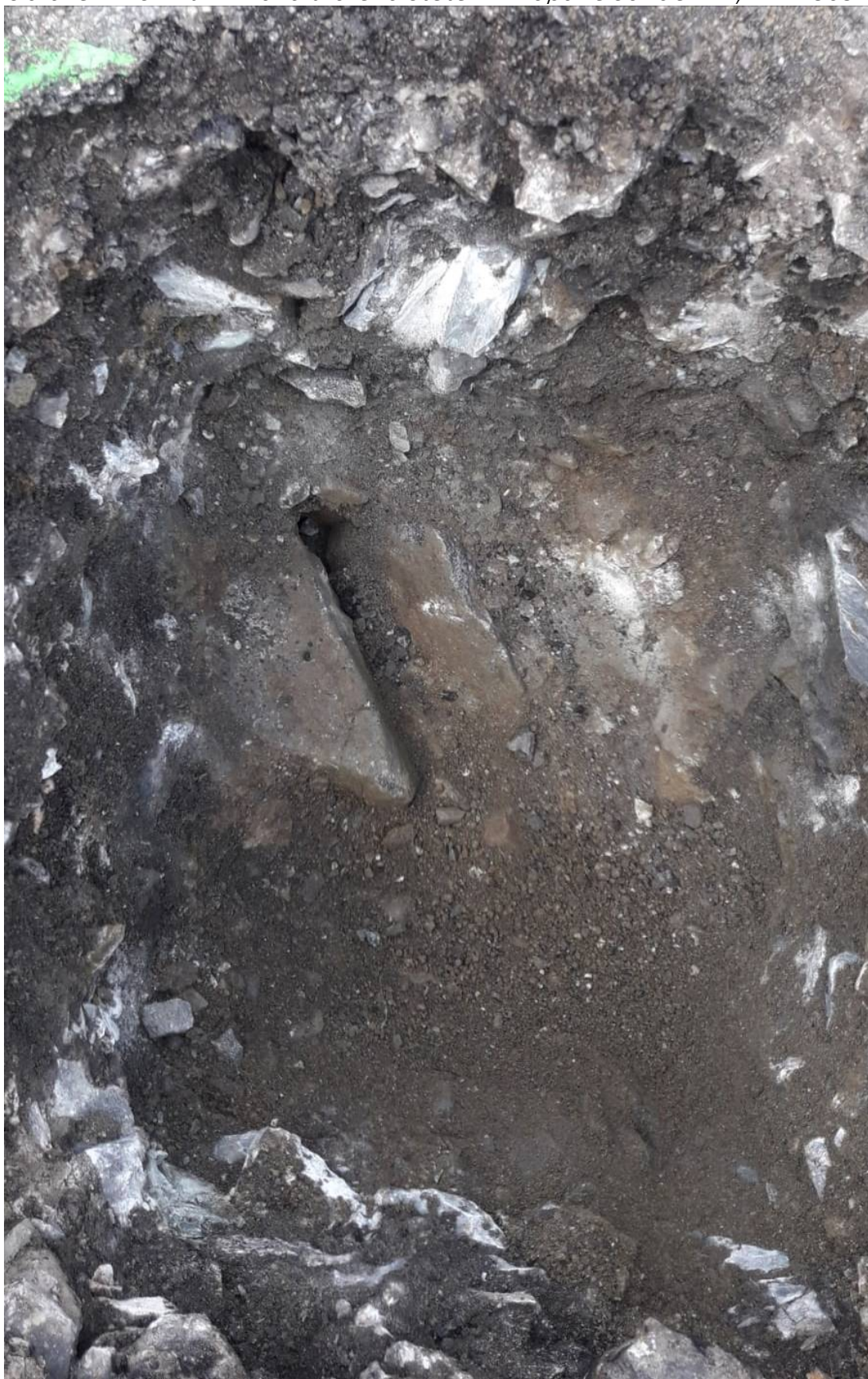
Obrázek B. 5 Aktivní zóna tvořena štětem v kopané sondě PZ2, km 2.303
