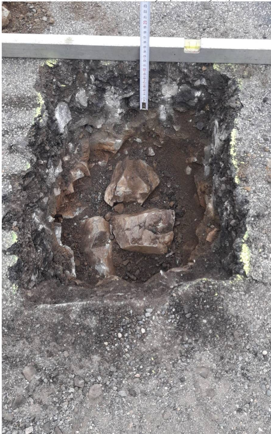
Obrázek B. 23 Skladba konstrukce vozovky kopané sondy SZ3, km 2.944
