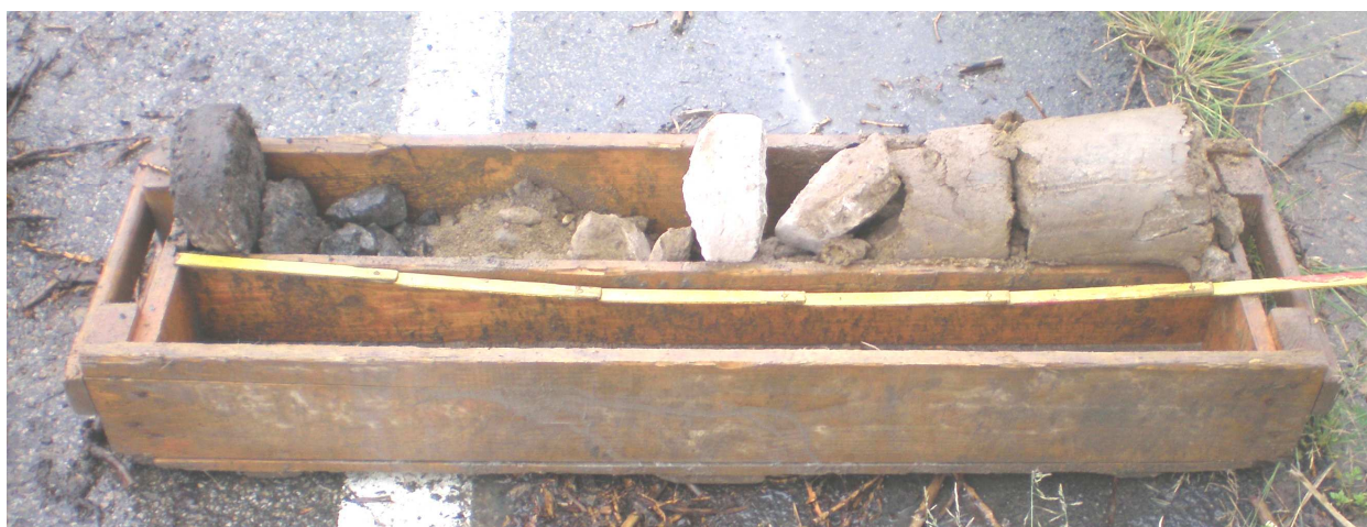
Obr. 5 Jádro z vrtu J 1 - kryt vozovky z asfaltového betonu měl tloušťku 6 cm, podklad z drceného granodioritu 12 cm a štět z křemenného dioritu 22 cm (v hloubce 0,38 až 0,60 m).
