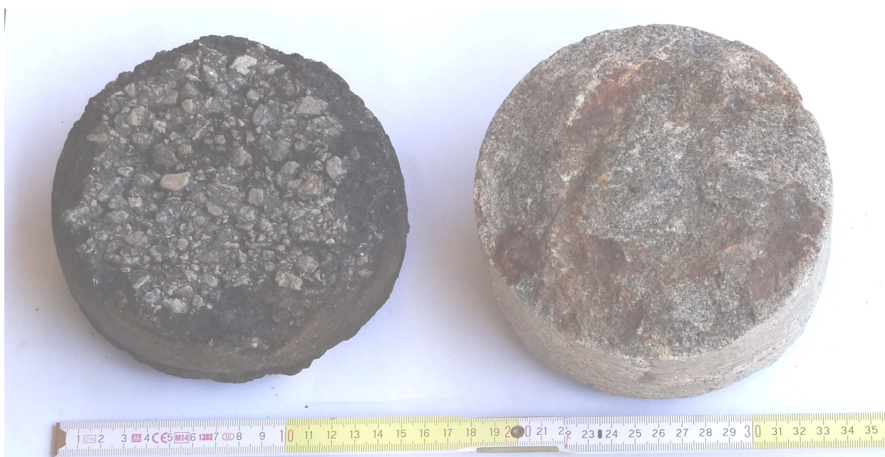
Obr. 6 Vrtné jádro J 1 průměru 156 mm – úseky z krytu vozovky a štětového podkladu.
