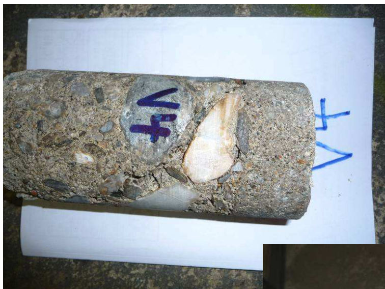
Získaný zkušební vzorek betonu V4 – válec Ø 100 mm = typický stav.
