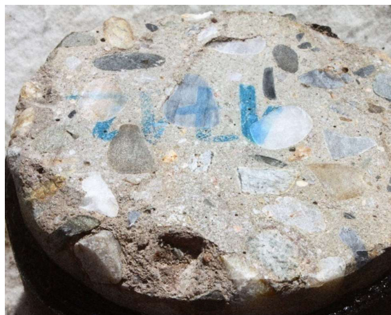
Obrázek č. 7: Vzorek CH1 po 75 zkušebních cyklech – vlevo zkušební povrch, vpravo rozpad dolní části zkušebního tělesa
