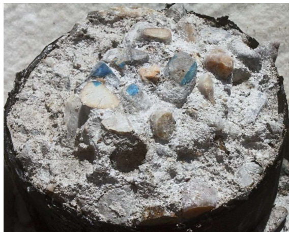
Obrázek č. 8: Vzorek CH2 po 75 zkušebních cyklech – vlevo zkušební povrch, vpravo rozpad dolní části zkušebního tělesa
