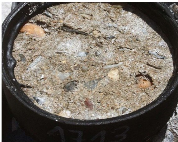
Obrázek č. 8: Vzorek CH2 po 75 zkušebních cyklech – vlevo zkušební povrch, vpravo rozpad dolní části zkušebního tělesa
