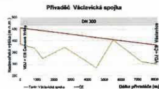
Obr.32 Schématický podélný profil přiváděče ze SVB pro variantu 2A
