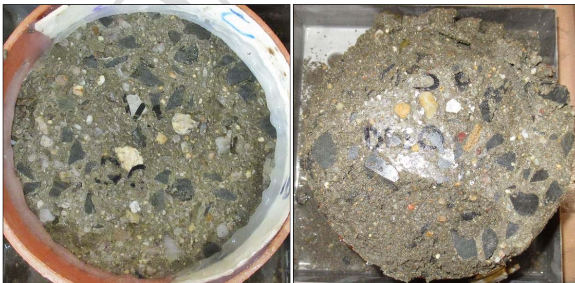
Foto 4: Pohled na líc a „dno“ vzorku V3 – po CH.R.L. - metoda C – 75 cyklů
