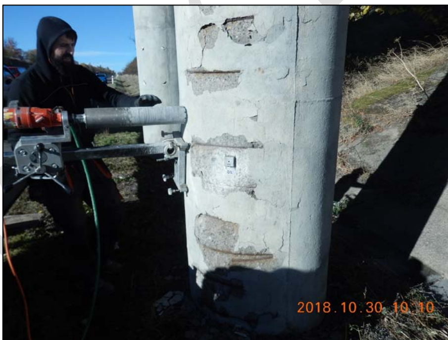
Foto 52: Pohled na střední sloup členěné podpěry P3 při odběru jádrového vývrtnu V2 ( \varnothing 95 mm)
