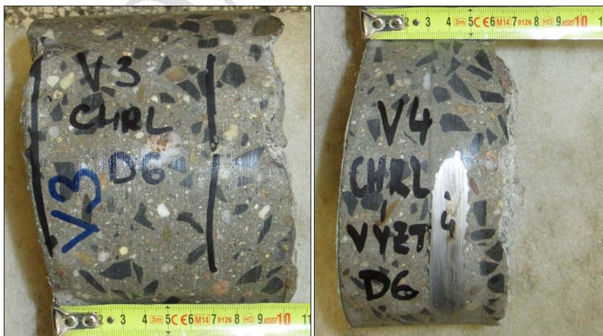
Foto 2: Pohled na odebrané vývrty V3 a V4; na vývrťech provedeny zkoušky odolnosti proti CH.R.L. – metoda C
