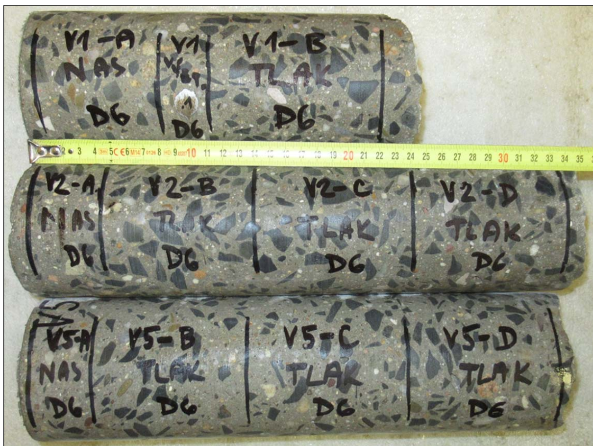
Foto 1: Pohled na odebrané vývrty V1, V2 a V5; z vývrťů připravena zkušební tělesa pro destruktivní stanovení pevnosti betonu v tlaku a pro stanovení nasákavosti betonu
