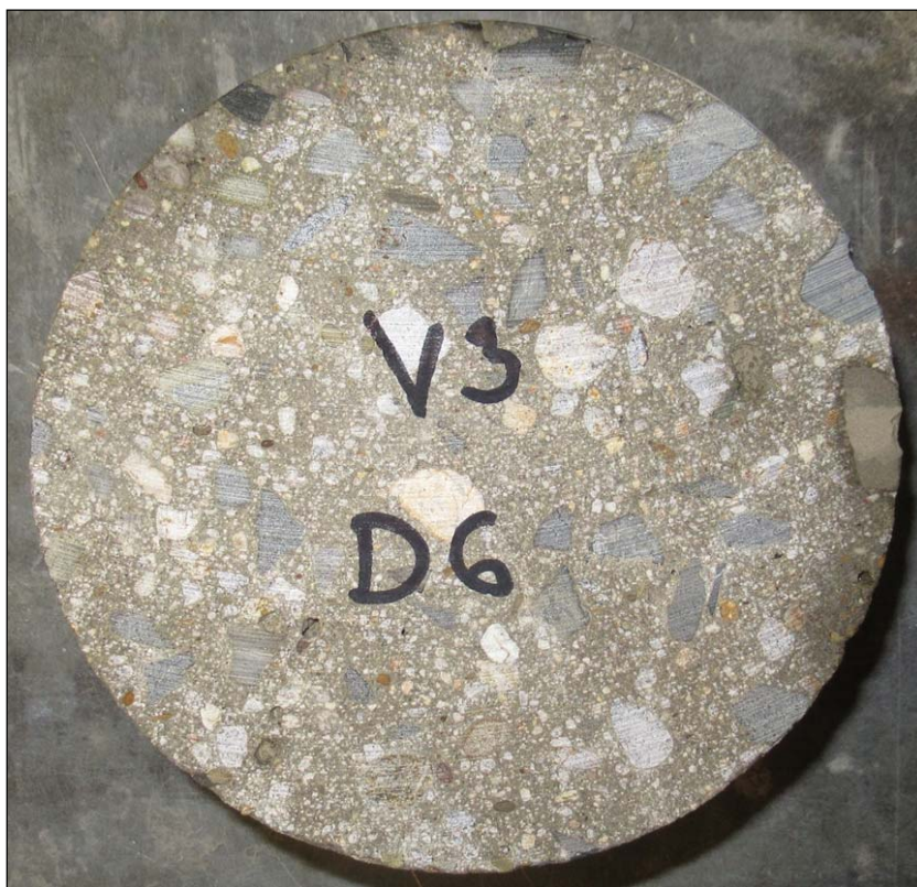
Foto 3: Pohled na líc vývrtnu V3 před zkouškou; z líce vývrtnu odstraněn nátěr, který byl na více než 40% plochy nesoudržný s podkladem; poškození nátěru vzniklo během jádrového vrtání
