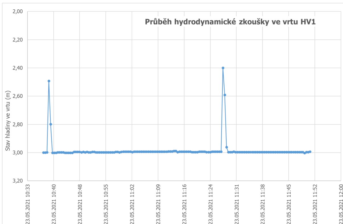
Graf 1 – Průběh hydrodynamické zkoušky (nálevová zkouška) ve vrtu HV1
