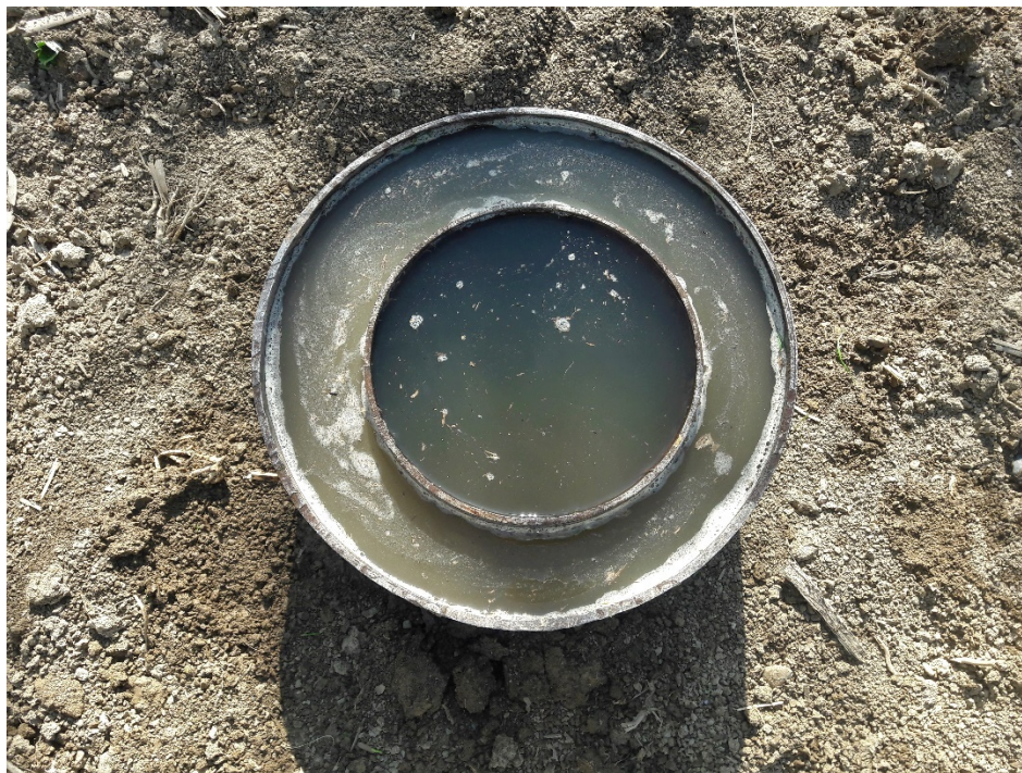
Obrázek 7 – Rozložení prstencového infiltrometru.
