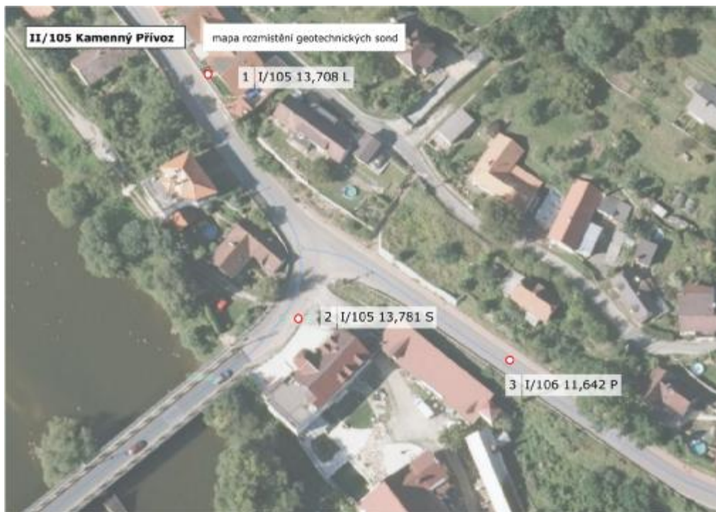
Obr. 4 - Mapa umístění geotechnických sond (pravý břeh)
