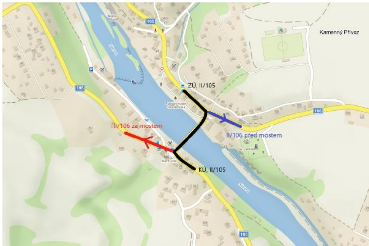
Obr. 5 - Schéma měření únosnosti (šipky u II/106 naznačují směr měření)
