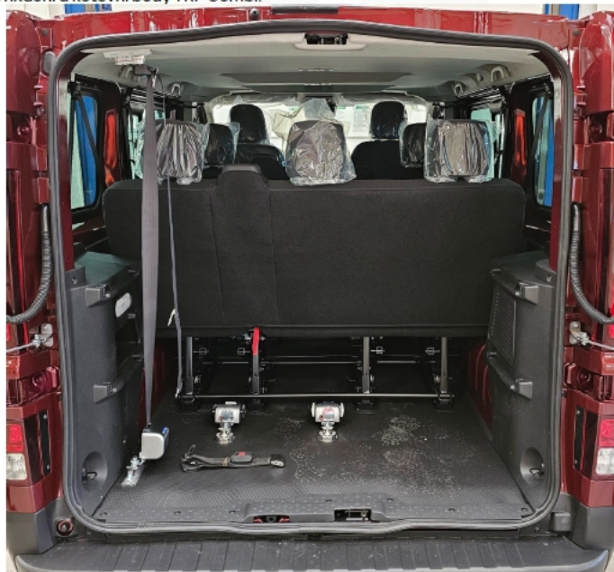
Příklad přestavby na modelu TRP Combi: Zadní fixační a kotevní body TRP Combi:
