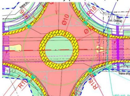
Plocha komunikace - skladba 4 (CB kryt řemeslná striáž)
