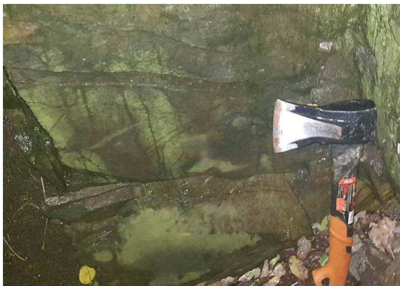
Foto.č.1: navětralé břidlice třídy pevnosti R4 až R3 (geotechnický typ Pr3/Pr4)
