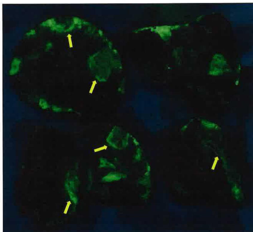
Foto 13: Celkový pohled na části vzorku V3-B při uranylacetátové zkoušce pod UV zářením s prokázanou přítomností alkalicko křemičitého gelu – žlutozelená fluorescence – svítí reakční lemy kolem zrn hrubého kameniva – viz žluté šipky
