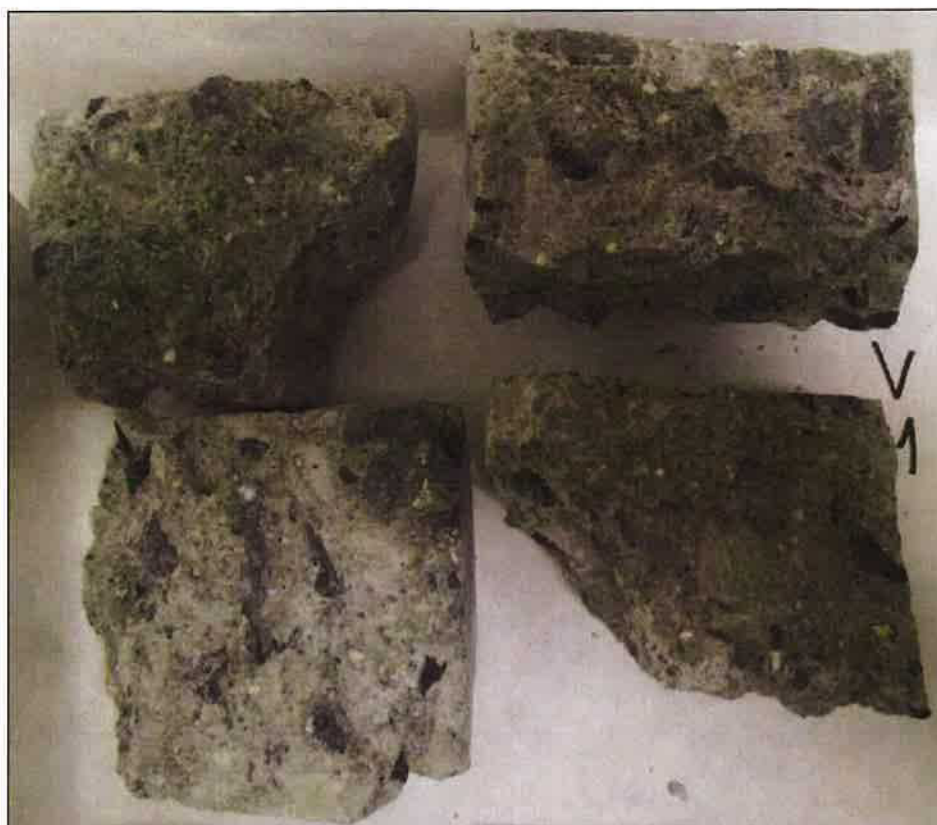
Foto 10: Celkový pohled na části vzorku V1-B před zkouškou na přítomnost ASR
