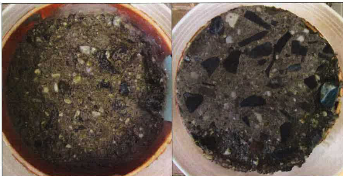
Foto 7: Pohled na čelo a dno vzorku CHRL1 – po CH.R.L. - metoda C – 50 cyklů (zaznamenán rozpad čela a částečný rozpad dna zkušebního vzorku)
