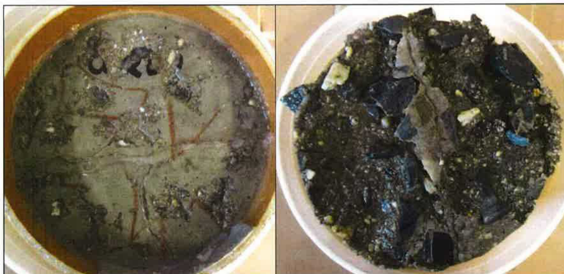
Foto 9: Pohled na čelo a dno vzorku CHRL2 – po CH.R.L. - metoda C – 75 cyklů (zaznamenán rozpad dna zkušebního vzorku)
