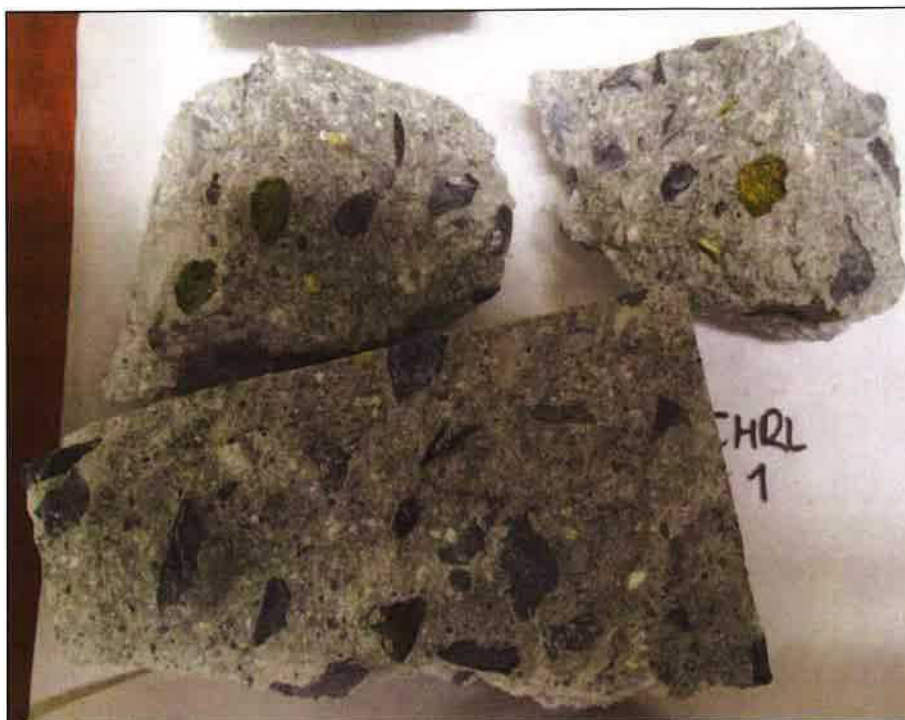
Foto 14: Celkový pohled na části vzorku CHRL1 před zkouškou na přítomnost ASR
