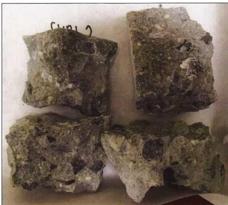
Foto 16: Celkový pohled na části vzorku CHRL2 před zkouškou na přítomnost ASR
