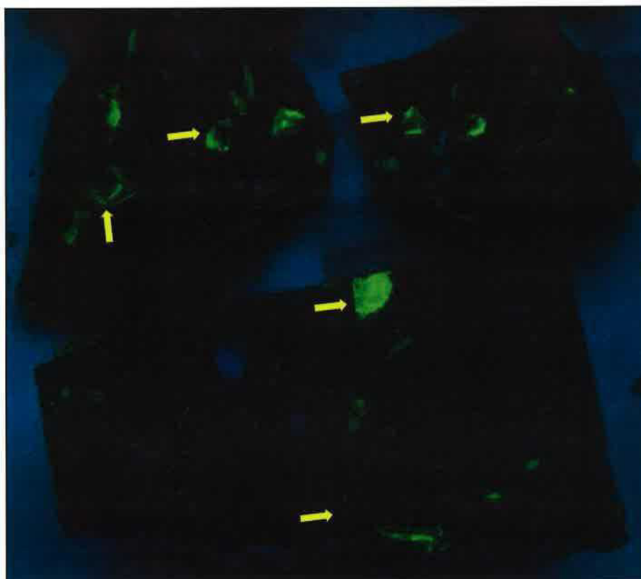
Foto 15: Celkový pohled na části vzorku CHRL1 při uranylacetátové zkoušce pod UV zářením s prokázanou přítomností alkalicko křemičitého gelu – žlutozelená fluorescence – svítí pár zrn hrubého kameniva – viz žluté šipky
