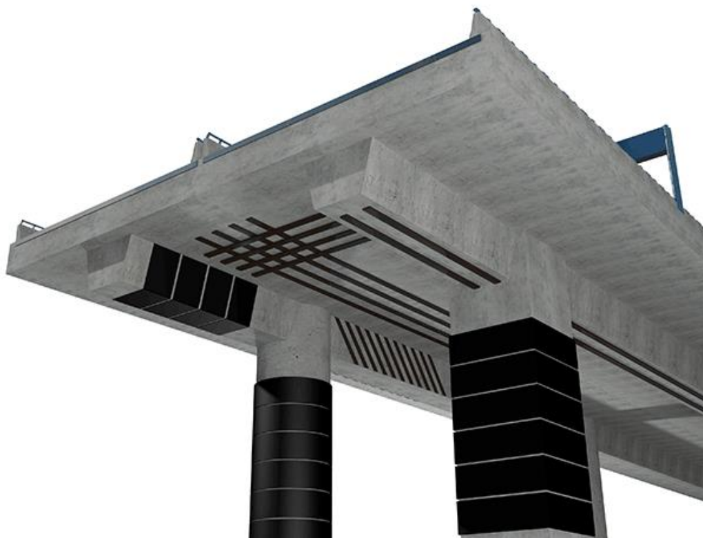
Obrázek 3 - Schéma možnosti zesílení lepenými lamelami
