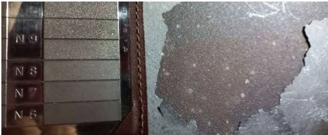
Hladkost podkladového kovu po omytí a jemném otryskání
