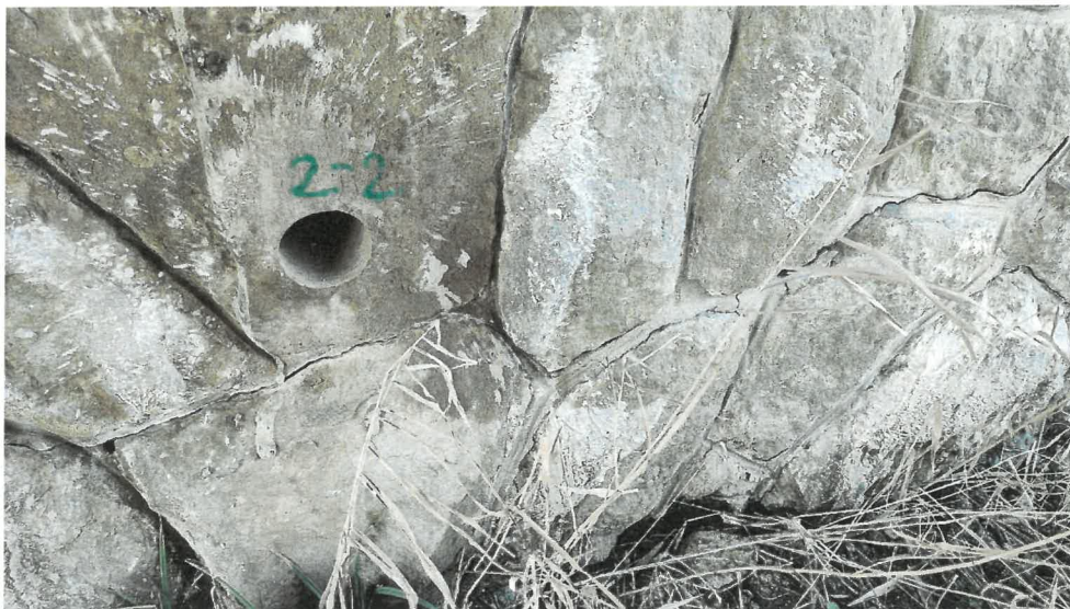
Obr: 13: Pohled na sondu po odběru jádrového vývrtu 2-2.
