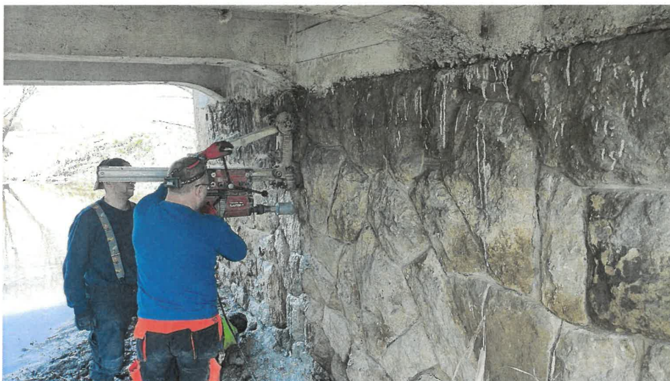
Obr. 8: Odběr jádrového vývrtnu z opěry č. 2 (směr Plazy).
