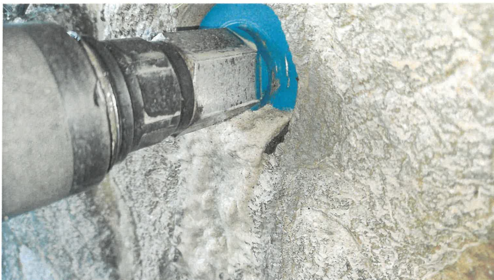
Obr. 10: Detail výnosu jádrového vývrtnu č. 2-3. Materiál některých kusovitých částí pískovce a pojiva se při odběru jádrového vývrtnu zcela rozplavil.
