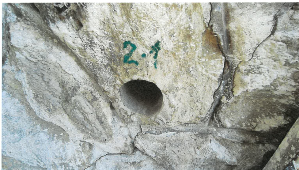
Obr. 11: Pohled na sondu po odběru jádrového vývrtnu 2-1.
