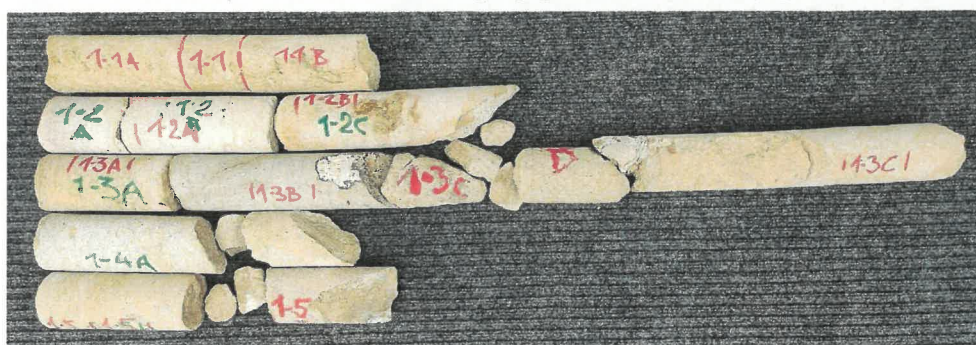
Obr. 23: Pohled na jádrové vývrty 1-1 až 1-5, které byly odebrány z opěry č. 1 (směr Kolomuty).
