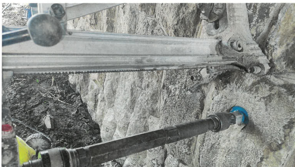
Obr. 9: Odběr jádrového vývrtnu č. 2-3, který byl prováděn přes celou tloušťku opěry (směr Plazy).
