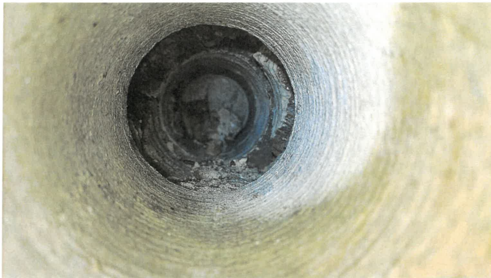
Obr. 7: Pohled do sondy po odběru jádrového vývrtnu 1-5. Při odběru jádrového vývrtnu docházelo k rozplavování pojiva i degradovaných úlomků kamene, které byly umístěny ve střední části konstrukce opěry.
