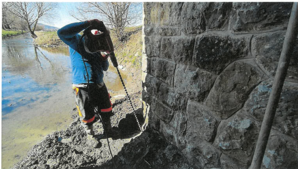
Obr. 21: Ověření hloubky založení mostní opěry pomocí navrtávky prodlouženým vrtákem.
