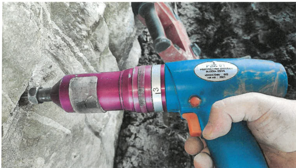
Obr. 19: Ověření pevnosti malty v ložné spáře pomocí Kučerovy vrtačky. Z povrchu spáry byla předem odvrtná opravná vrstva cementové malty, vlastní zkouška byla následně provedena na původním pojivu.
