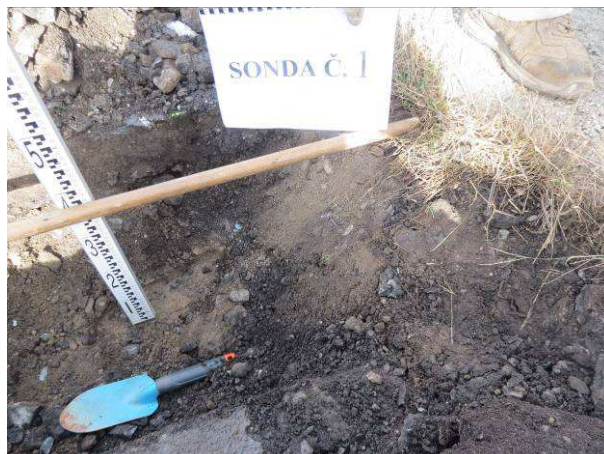
Sonda č.1 – materiál krajnice
