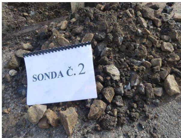
Sonda č.2 – materiál konstrukční vrstvy
