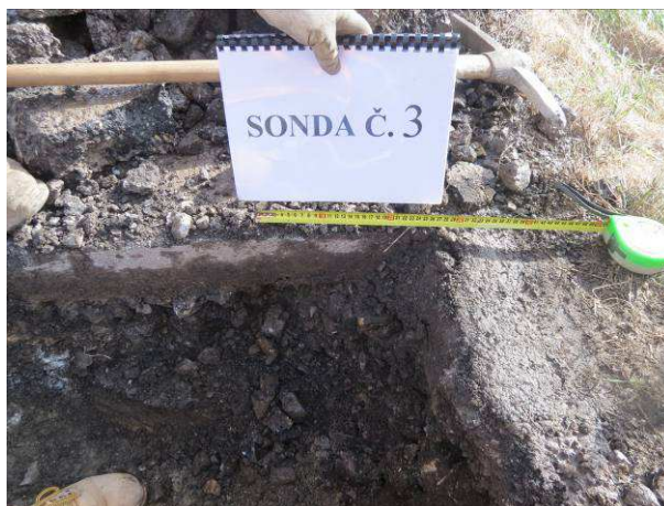
Sonda č.3 – nedostatečná asfaltová vrstva
