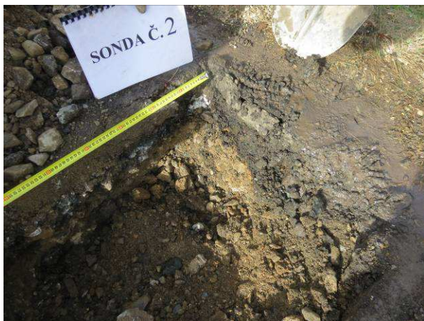
Sonda č.2 – krajnice, nedostatečná vrstva asfaltu
