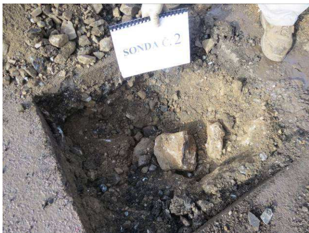
Sonda č.2 – štět v úrovni zemní pláň
