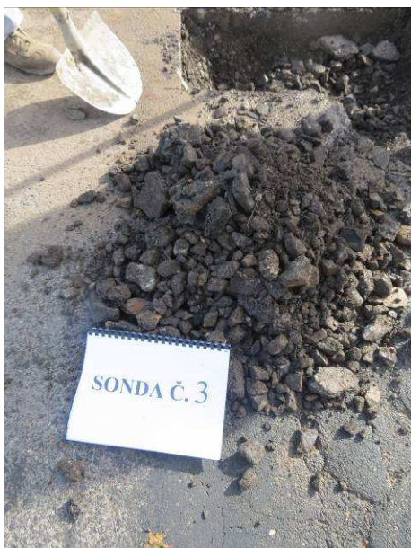
Sonda č.3 – materiál konstrukční vrstvy
