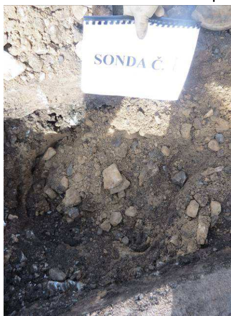
Sonda č.1 – materiál zemní pláň
