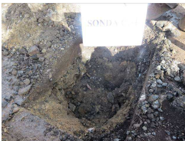
Sonda č.4 – štět v úrovni zemní pláň
