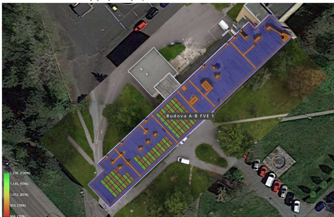
Obrázek č. 4.9.4.6: Schéma efektivity výroby elektřiny FV panelů
