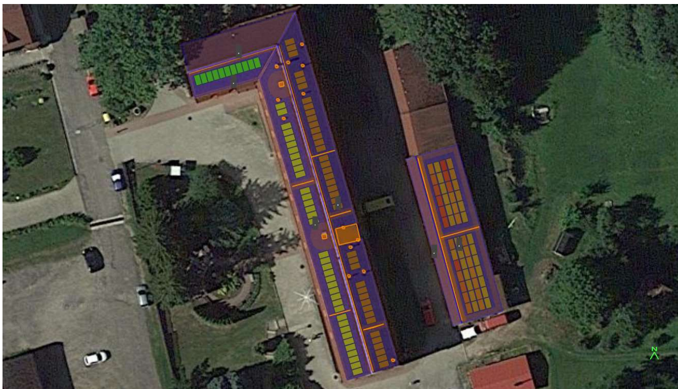
Obrázek č. 4.9.4.4: Schéma efektivity výroby elektřiny FV panelů
