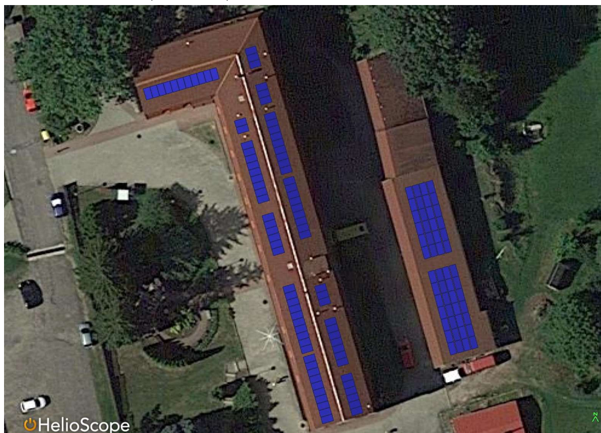
Obrázek č. 4.9.4.1: Rozložení panelů/Plocha pro umístění FVE
