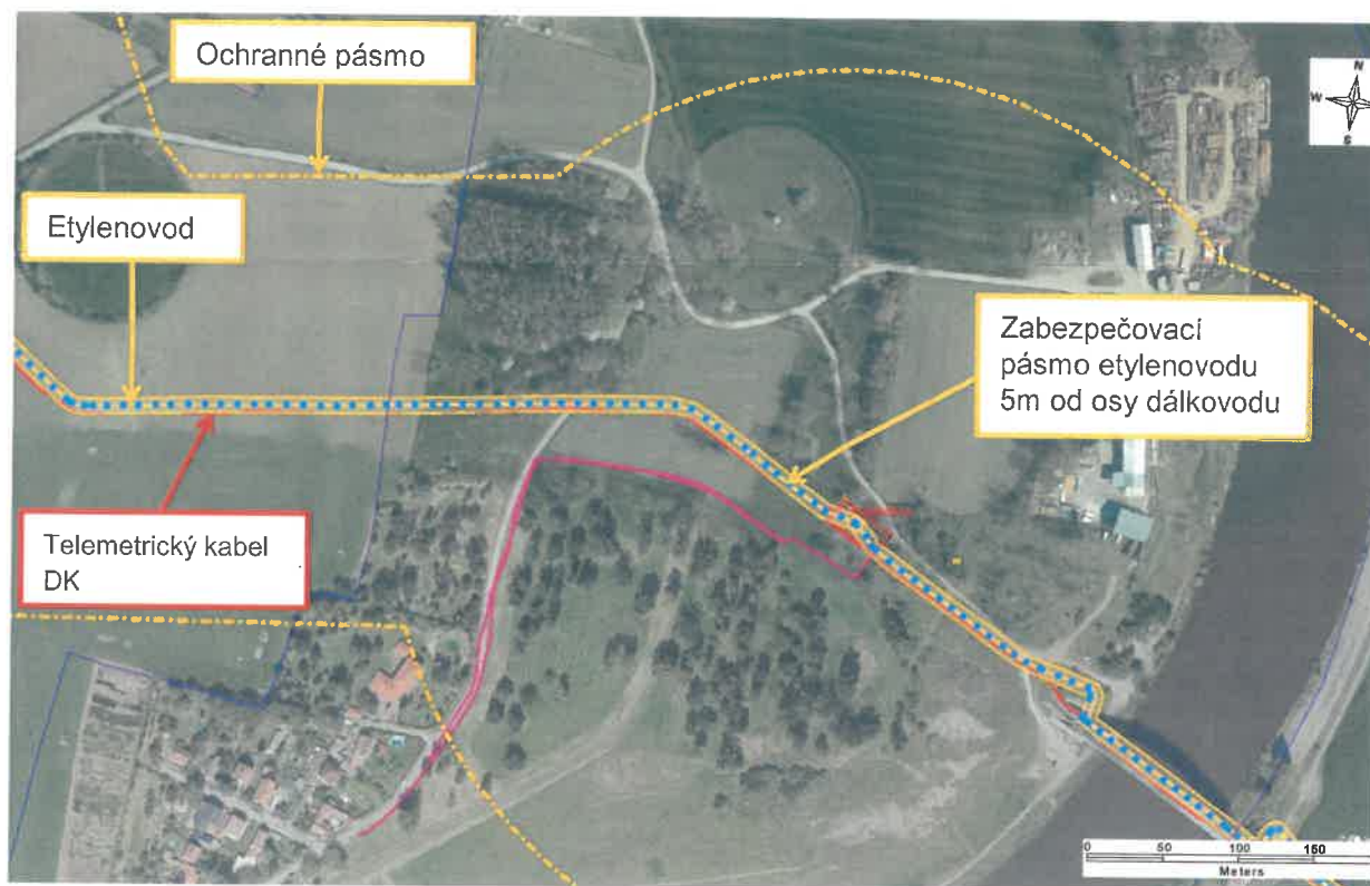
Obrázek č.1: Etylenovod, zabezpečovací pásmo 5 m a Doprovodný telemetrický kabel DK
