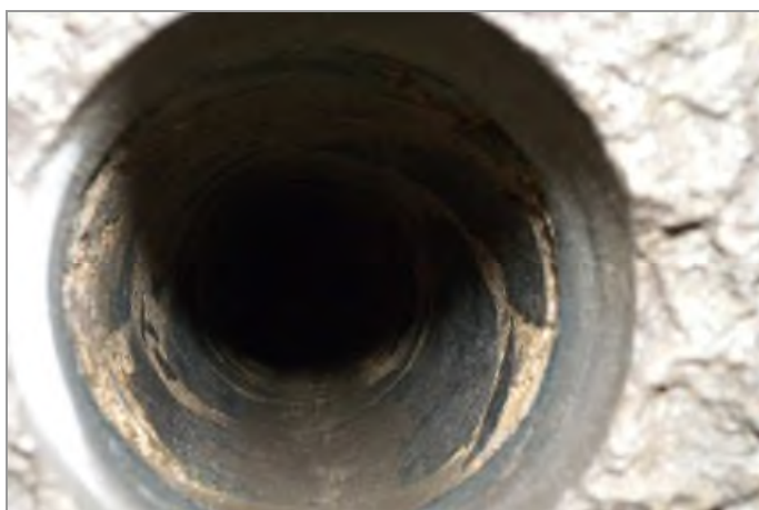
foto 9, 10: Pohled do ústí šikmého vrtu Š-1 pro ověření založení jižní opěry a detail vrtného jádra
