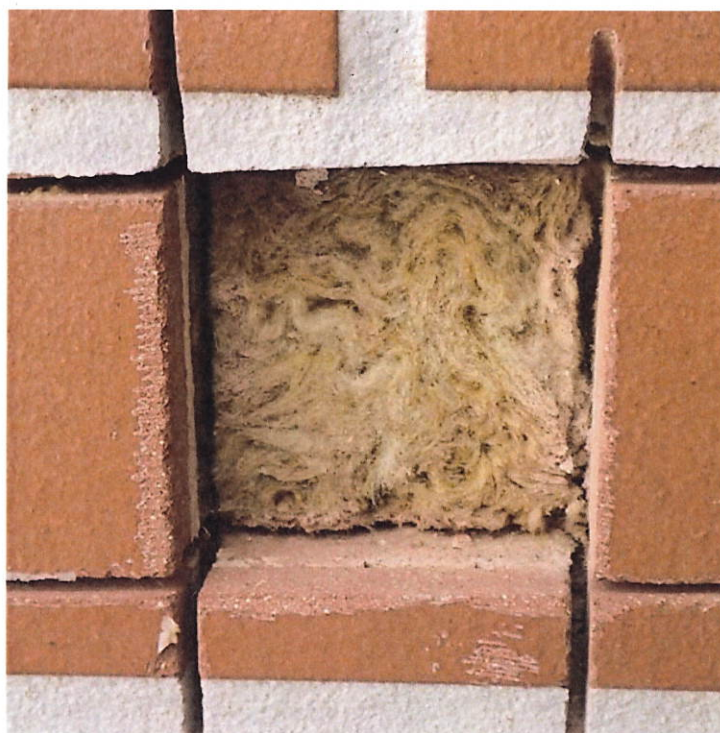
Obr. 11: Místo porušení vzorku č. 13 na rozhraní základní vrstvy a lepidla
