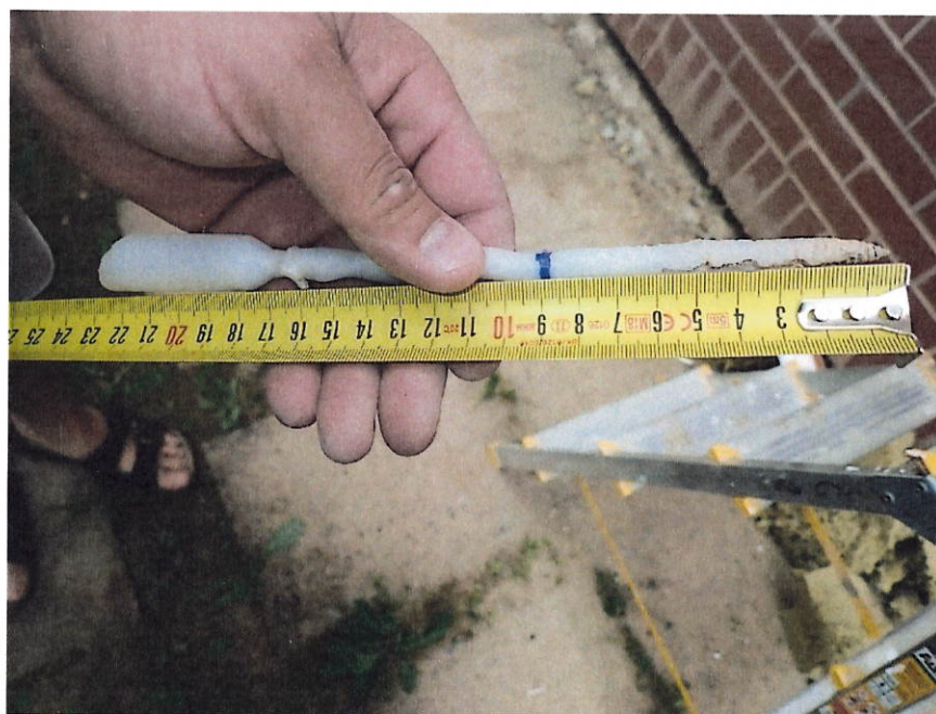
Obr. 3.13: Sonda 3, hloubka kotvení ocelového trnu se závitem do původního zdiva
