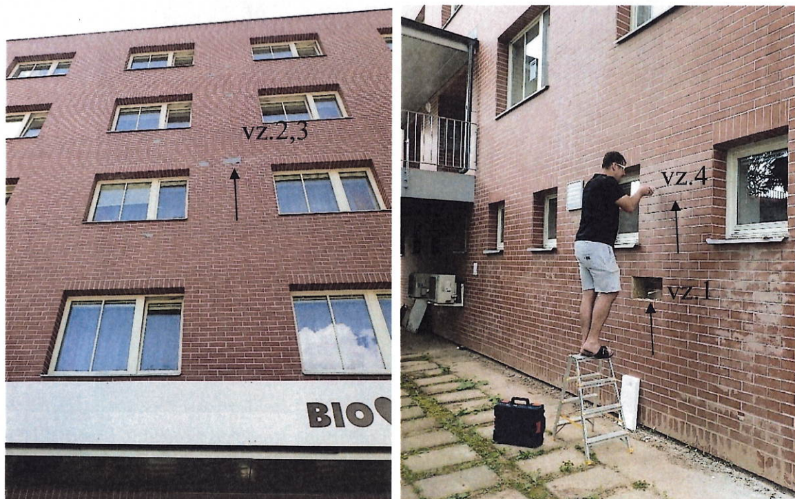
Obr. 13, 14: Místa odběru vzorků minerální vlny pro gravimetrické zjištění vlhkosti izolantu
