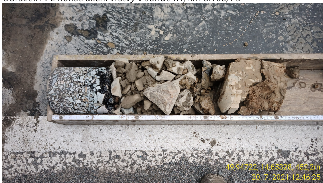
Obrázek A. 2 Konstrukční vrstvy v sondě K1, km 0.100, PS
