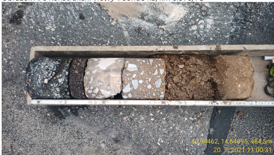
Obrázek A. 6 Konstrukční vrstvy v sondě K3, km 0.570, PS
