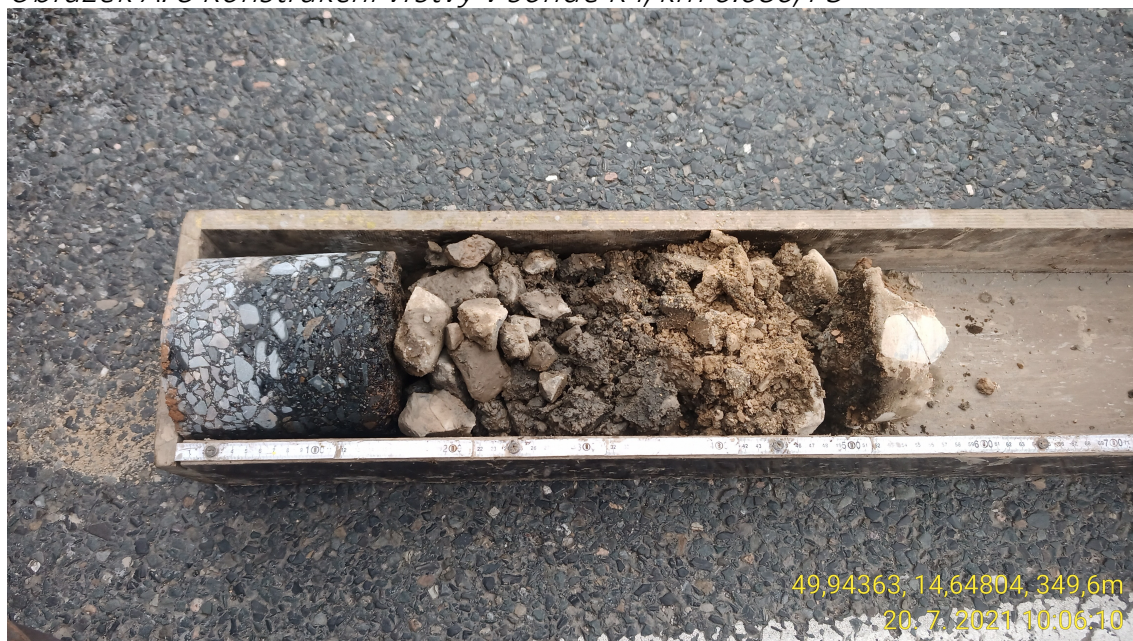
Obrázek A. 8 Konstrukční vrstvy v sondě K4, km 0.680, PS
