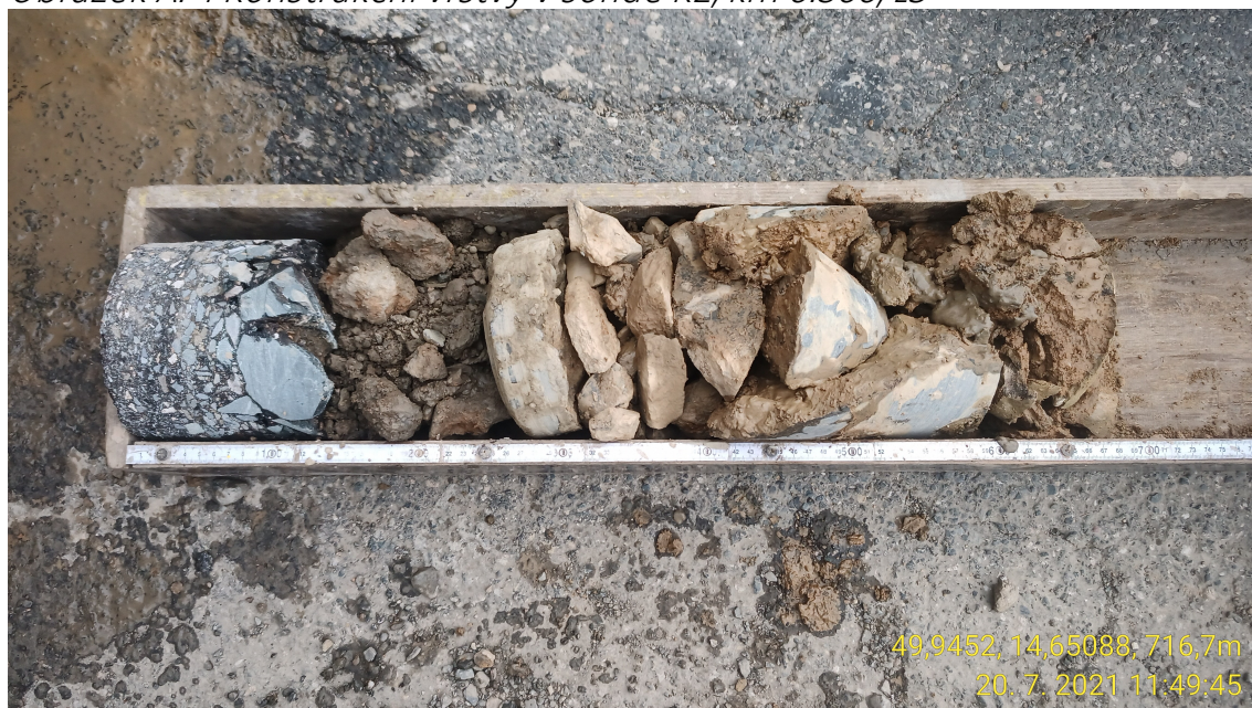
Obrázek A. 4 Konstrukční vrstvy v sondě K2, km 0.300, LS
