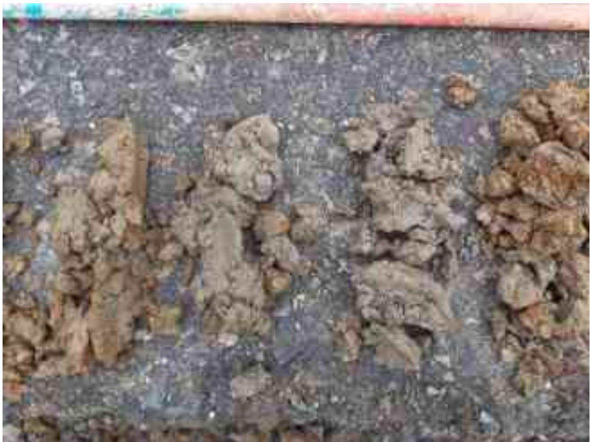
Obrázek 6 - VS-2 - návrty - střední část - šedé jíly tuhé
