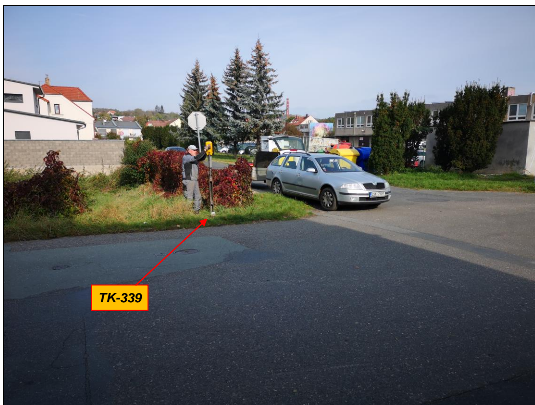
Foto č. 14-15 : Hloubení průzkumných jádrových sond TK-338 a TK-339 elektrickou sondážní soupravou WACKER EH 230/23 (konečná hloubka sond 1,00 m, průměr jádra 80 mm – foto 20.10. 2020)
