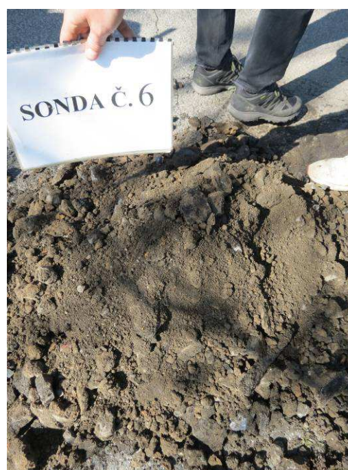
Obr.13.F Sonda č.6 – materiál konstrukční vrstvy
