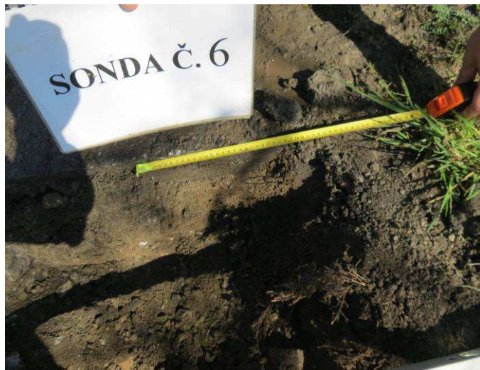
Obr.14.F Sonda č.6 – detail krajince bez konstrukční vrstvy
