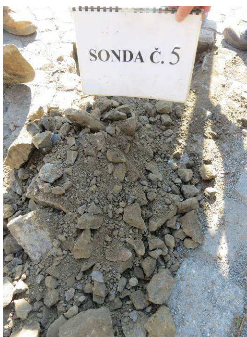
Obr.9.F Sonda č.5 – materiál konstrukční vrstvy
