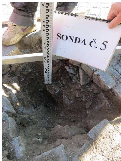
Obr.6.F Sonda č.5 - celková hloubka sondy
