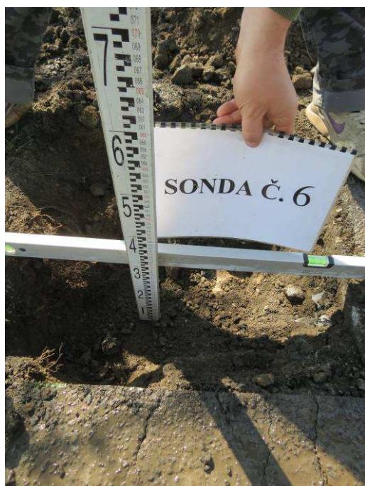
Obr.12.F Sonda č.6 - celková hloubka sondy
