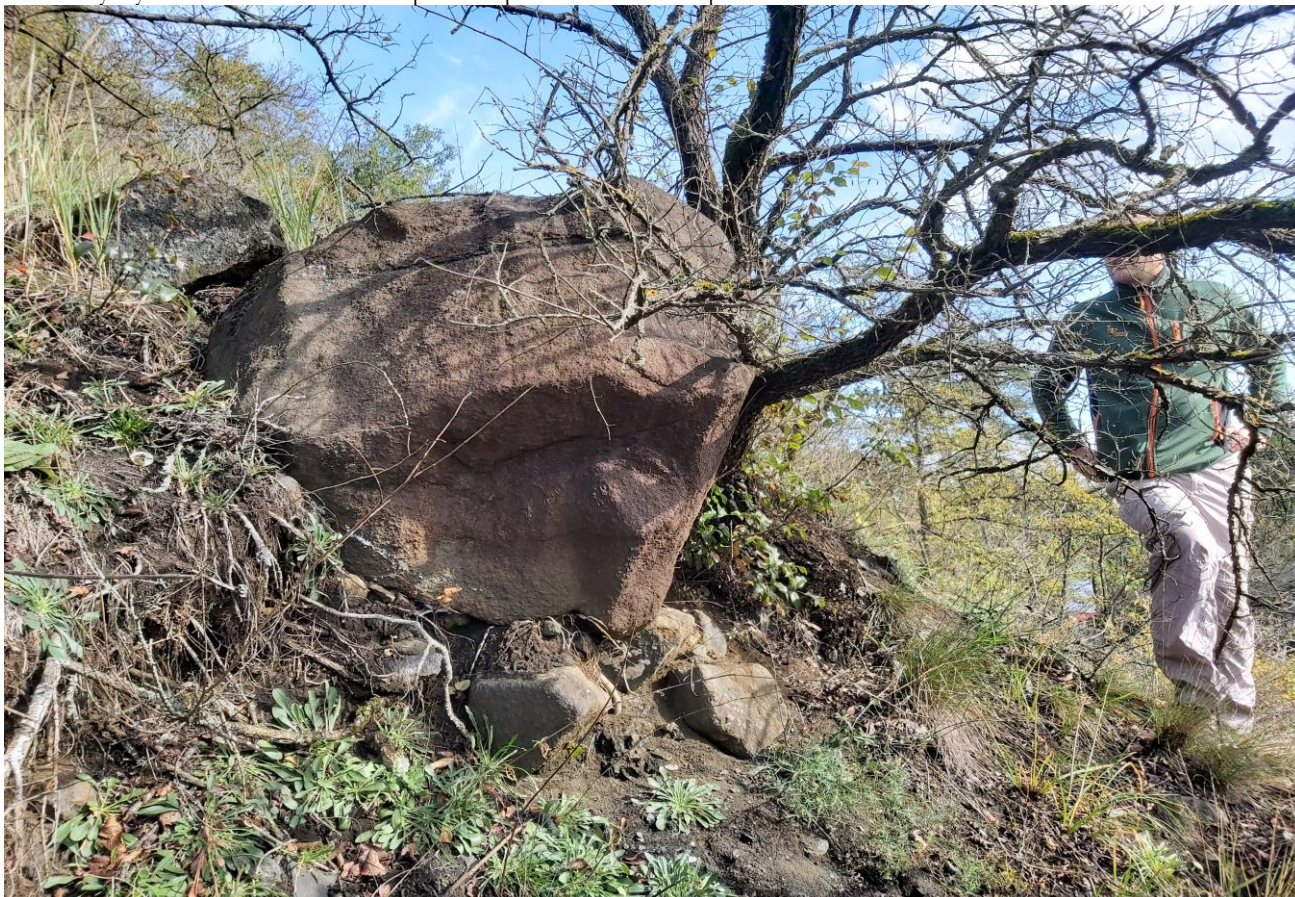
Foto 2 Posuzovaný horninový blok spočívající na nestabilním podloží charakteru hlinitokamenitého deluvia.
